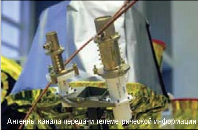
Антенны канала передачи телеметрической информации
