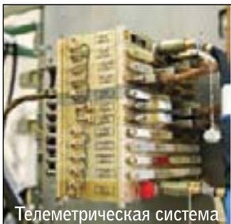
На любом приборе в составе космического аппарата имеются чувствительные датчики, каждый из которых регистрирует определённые параметры. Например, значения токов и напряжений, поворотных углов (антенн или солнечных батарей) и другие данные, по которым можно судить о работе спутника. С датчиков все данные поступают в центральный блок телеметрических измерений, в памяти которого преобразуются в цифровой формат, «упаковываются» в определённой структуре и передаются на наземные средства контроля.
