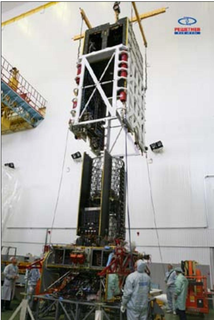
Телекоммуникационный спутник «Ямал-401» создается на железногорском предприятии по заказу ОАО «Газпром космические системы». В его основу легла платформа тяжелого класса «Экспресс-2000» разработки ОАО «ИСС». Масса спутника составит более 3 тонн, срок активного существования – 15 лет.
