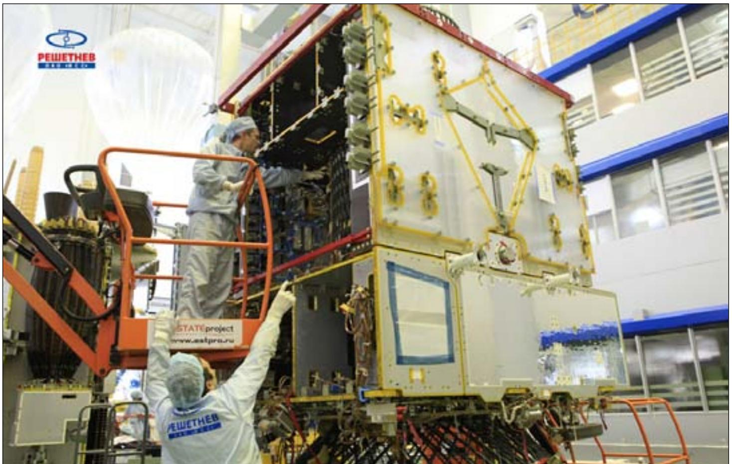
В ходе работ специалисты стыкуют платформу с полезной нагрузкой космического аппарата, которые создавались автономно как отдельные модули. На этом этапе также проводится интеграция их кабельных сетей.
