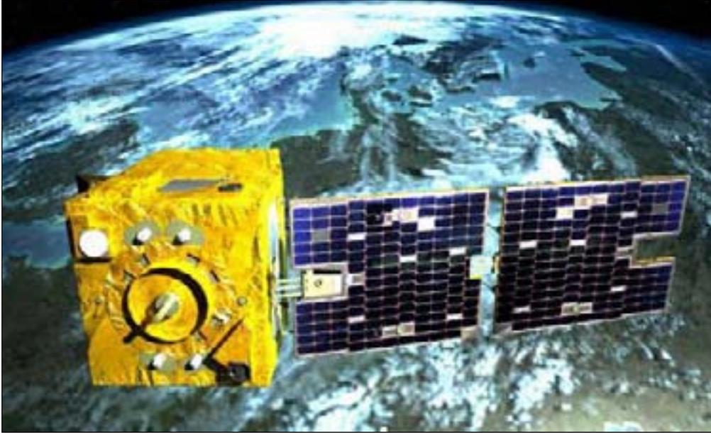
Спутник для оптического наблюдения VNREDSat-1A будет вводиться на солнечно синхронную орбиту (SSO) с высотой 670 км. Масса спутника 120 кг
