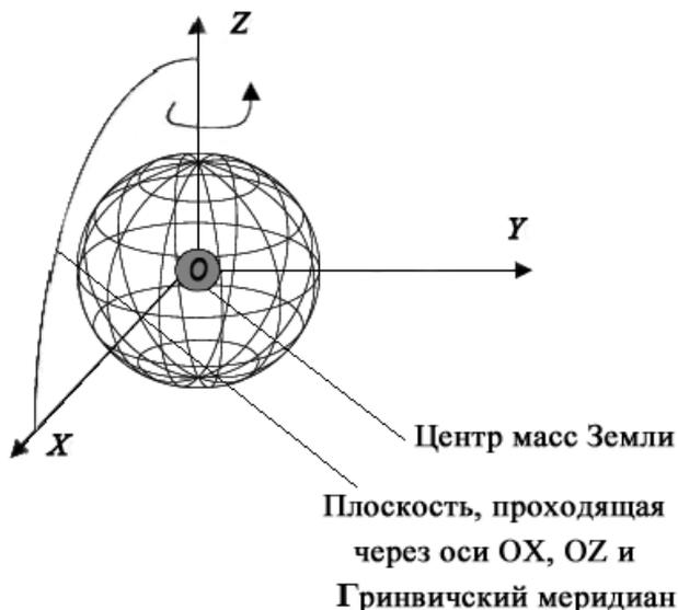
Рис. П.2. Геоцентрическая гринвичская система координат
