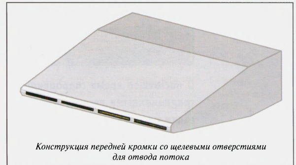
Конструкция передней кромки крыла из углеродно-кремниевого сплава
