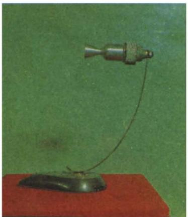
Первый в мире экспериментальный электрический ракетный двигатель (ЭРД) электротермического типа, разработанный В. П. Глушко.
