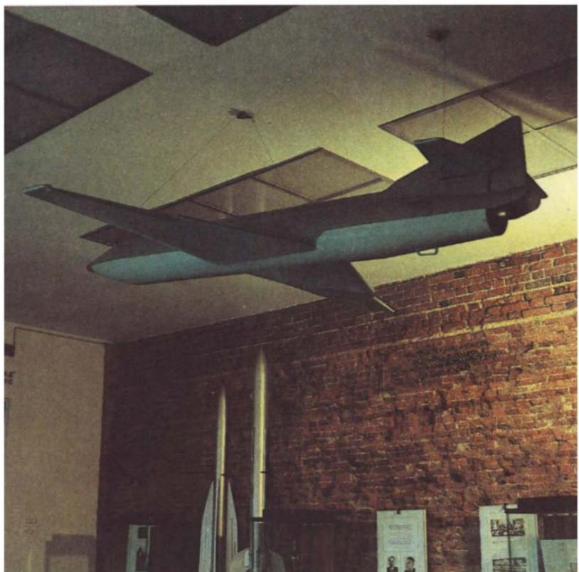
Модель крылатой ракеты 212 конструкции С. П. Королева с двигателем ОРМ-65. Разработана в РНИИ. Прошла испытания в 1936 году.
