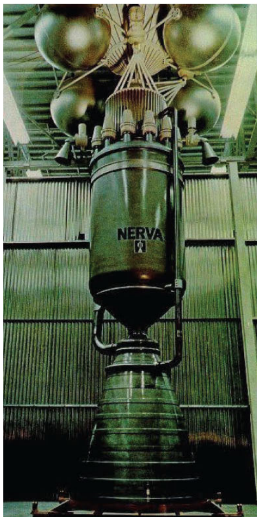
Установка NERVA (США) в сборке с баками для жидкого водорода
