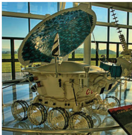
«Луноход-1». Изотопный источник тепловой энергии расположен сзади, в районе девятого колеса
