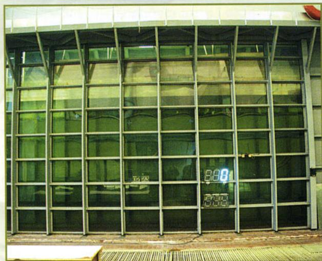
**Стендовый комплекс радиотехнических испытаний** предназначен для отработки и испытаний крупногабаритных антенных систем космического и наземного базирования, характеристик рассеяния объектов и представляет собой компактный полигон на базе радиоколлиматоров с размерами зеркал (16 x 15,5) м и (5 x 5) м, размещенных в безхвостых камерах.
