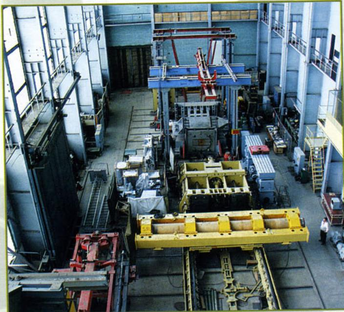
**Стендовый комплекс по отработке силовых установок и их агрегатов, систем терморегулирования и систем разделения** обеспечивает испытания пиротехнических систем и систем разделения; испытания ВРД и топливных систем; отработку механизмов; испытания на герметичность; тепловакуумные испытания.
