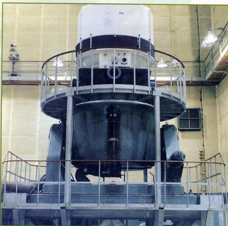
Лаборатория модальных испытаний конструкций выполняет работы по исследованию упругих динамических характеристик сложных конструкций и определению их реакции на динамические воздействия с использованием автоматизированной системы модальных испытаний «PRODERA». Размер испытуемых объектов: длина до 15 м; диаметр до 4 м; масса до 30000 кг; диапазон исследуемых частот от 0,2 до 400 Гц; количество каналов возбуждения до 8; максимальное усилие 1000 Н; количество измеряемых каналов до 200.
