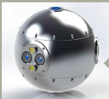
Рис. 7. Робототехническая подсистема технического зрения, управления и связи разработки ФГУП ЦНИИмаш
