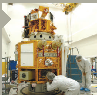
Рис. 5.1, 5.2. Эксперимент Orbital Express. Сервисный спутник ASTRO, оснащенный манипулятором, и спутник-клиент NextSat
