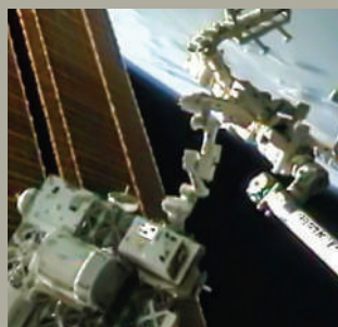
Рис. 13. Орбитальный эксперимент Robotic Refueling Mission. Платформа с размещенным на ней оборудованием и инструментами, манипуляторы Dextre и Canadarm-2
