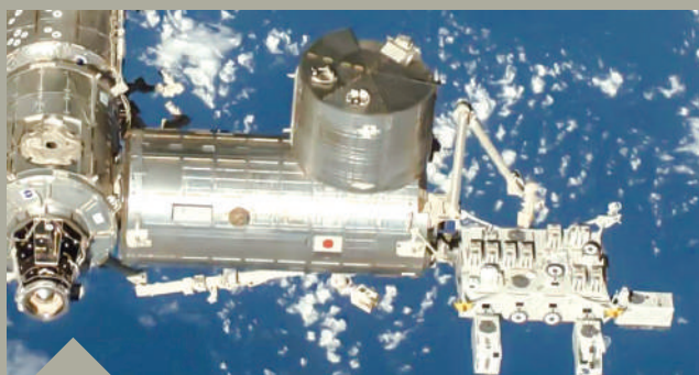
Рис. 3. Японский экспериментальный модуль МКС, оснащенный манипуляционной системой Japanese Experiment Module Remote Manipulator System (JEMRMS)
