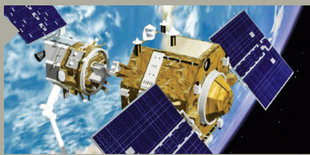
Рис. 4. Базовый сервисный спутник и субспутник-клиент для орбитального эксперимента ETS-VII по отработке технологий автономного роботизированного сервисного обслуживания, 1997–1999 гг.
