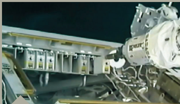
Рис. 11. Операция по замене блока ORU при помощи SPDM [12]
