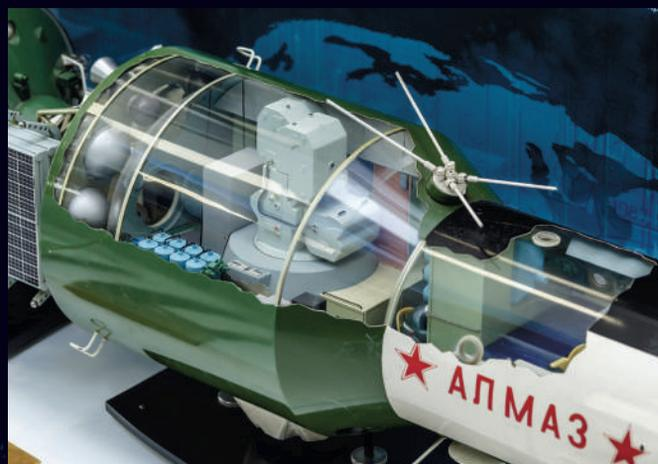
Макет орбитальной станции «Алмаз». В разрезе видно расположение фотоаппарата «Агат 1», занимавшего большую часть объема рабочего отсека. Рядом с макетом фотоаппарата видно восемь капсул спецформации
