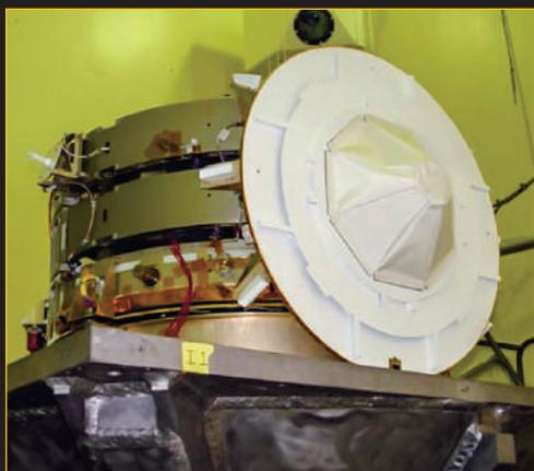
Рисунок 2. Бортовая аппаратура радиоэлектронного наблюдения Corperfield-2
