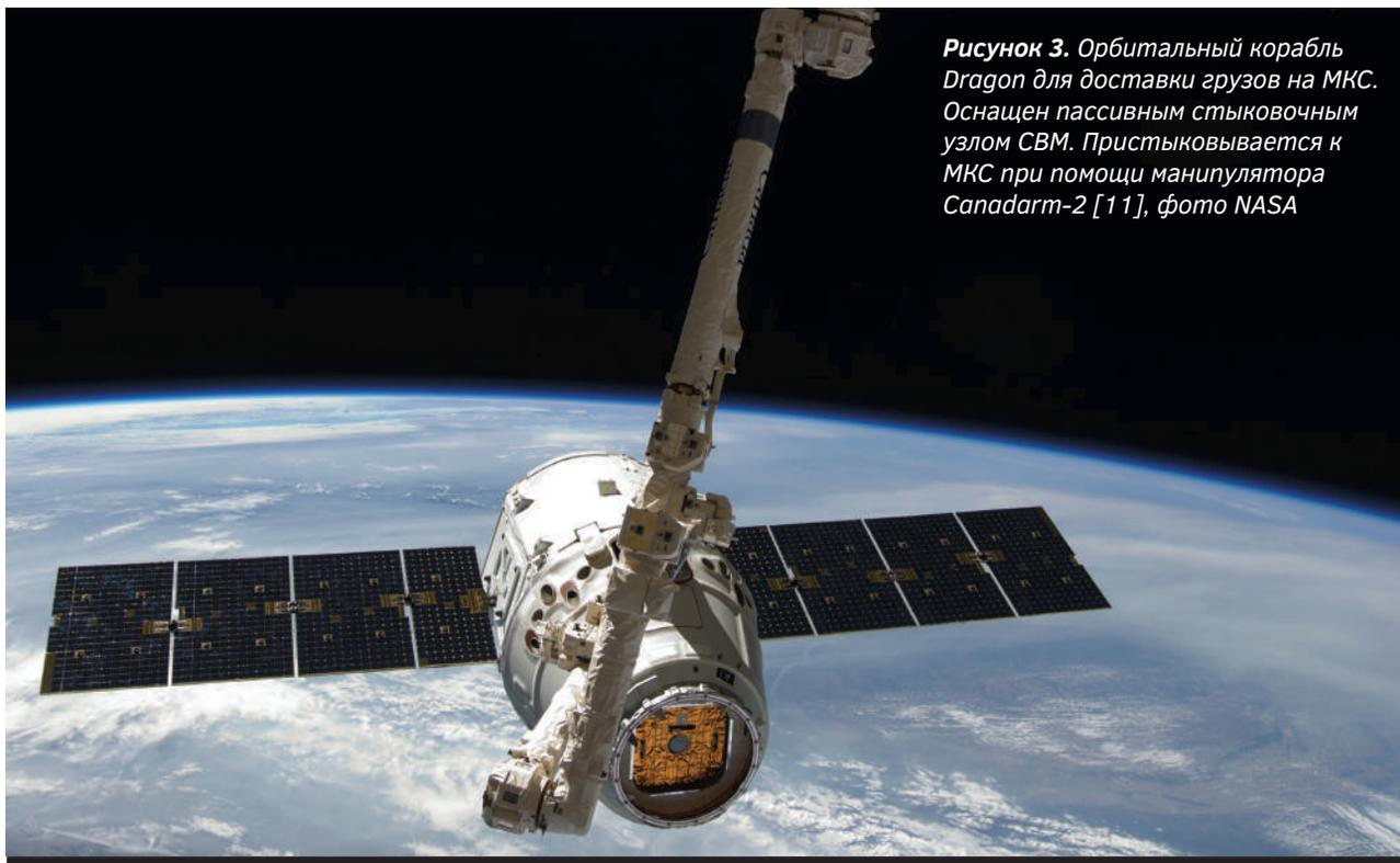
**Рисунок 3.** Орбитальный корабль Dragon для доставки грузов на МКС. Оснащен пассивным стыковочным узлом СВМ. Пристыковывается к МКС при помощи манипулятора Canadarm-2 [11], фото NASA
