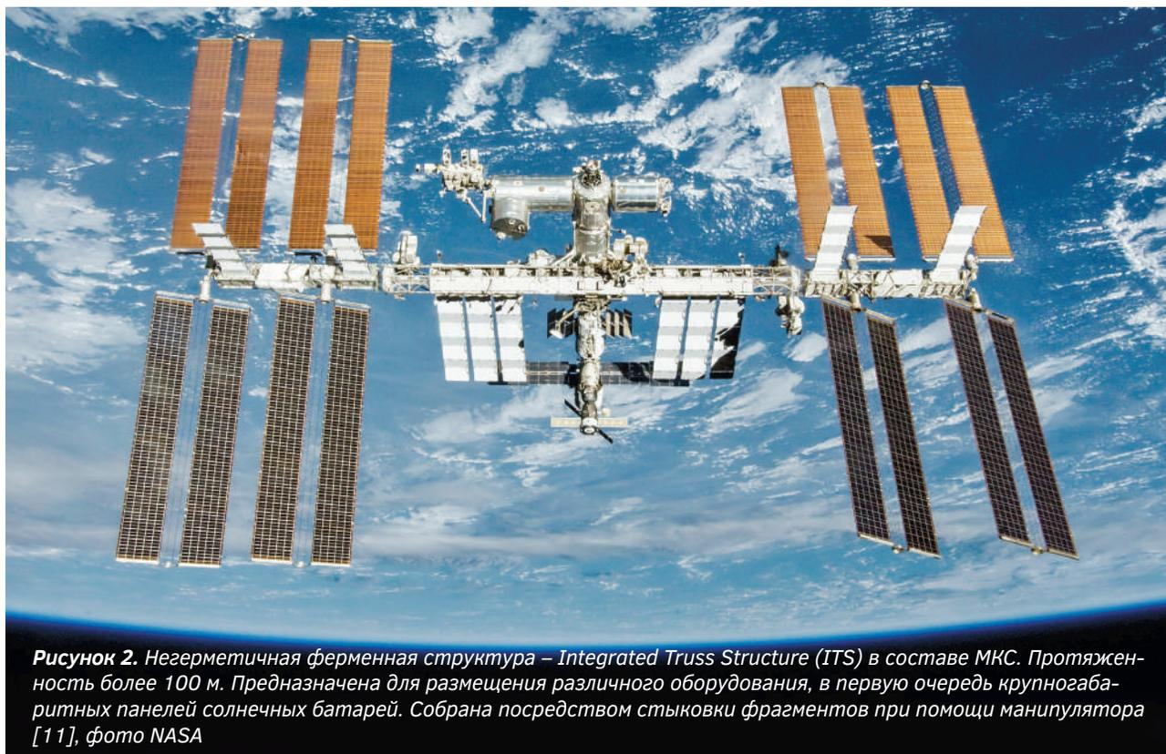
**Рисунок 2.** Негерметичная ферменная структура – Integrated Truss Structure (ITS) в составе МКС. Протяженность более 100 м. Предназначена для размещения различного оборудования, в первую очередь крупногабаритных панелей солнечных батарей. Собрана посредством стыковки фрагментов при помощи манипулятора [11], фото NASA
