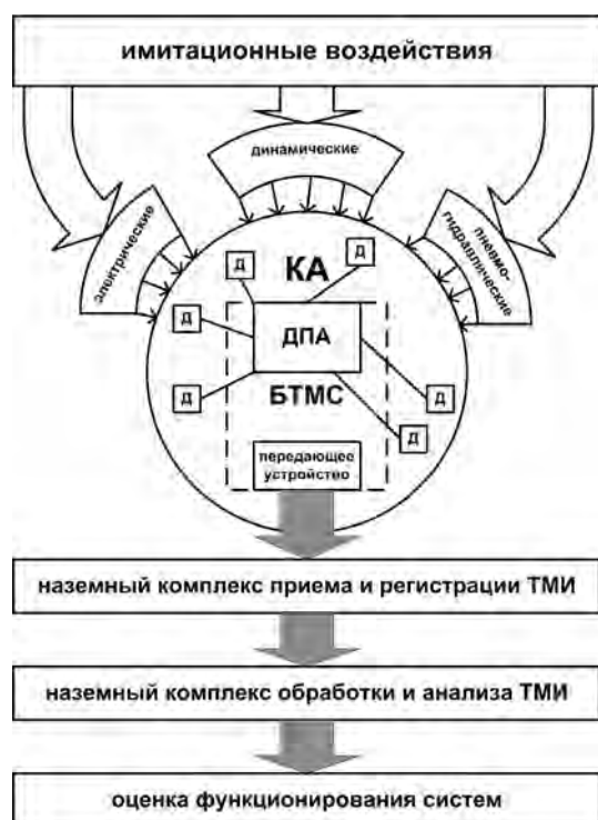
рисунк 1. Функциональная схема процесса проведения ЗКИ
