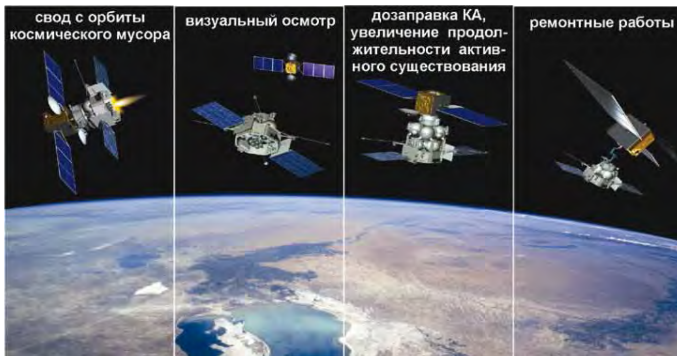
рисунок 4. Возможные варианты АКА для инспекции, обслуживания и свода с орбиты космического мусора
