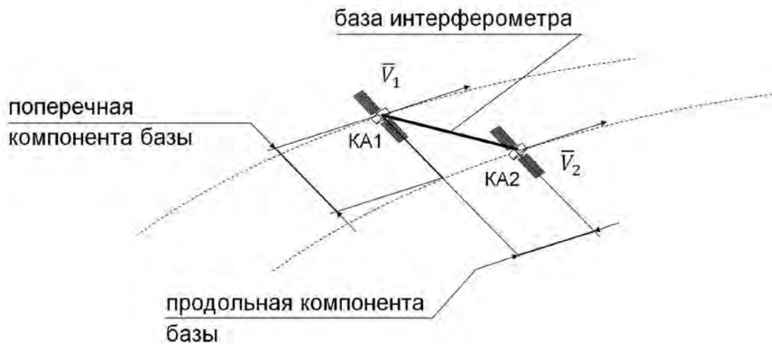
рисунок 2. Компоненты базы интерферометра в плоскости движения КА
