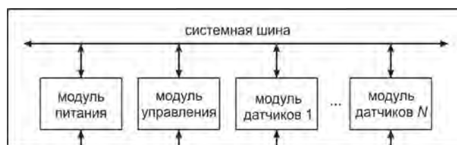
рисунок 3. Структурная схема телеметрической системы
