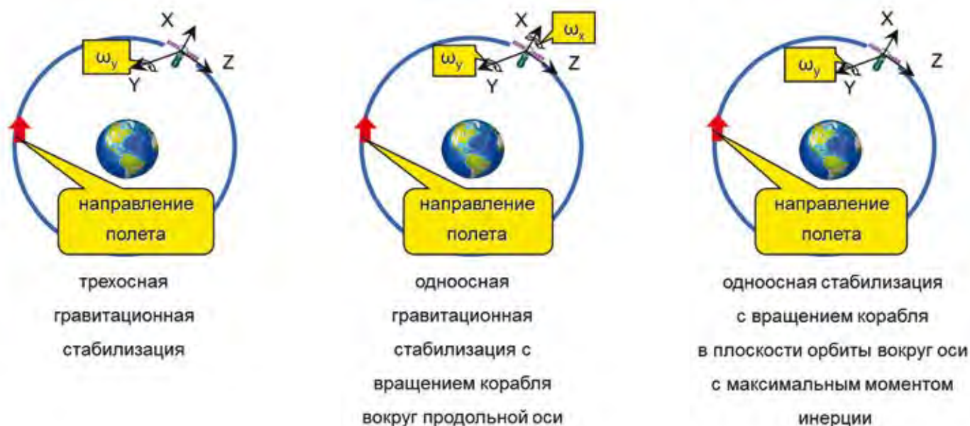
рисунок 2. Схемы реализации режимов пассивной стабилизации
