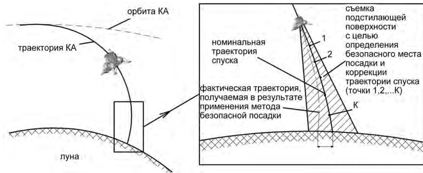
рисунок 2. Динамический способ определения безопасного района посадки
