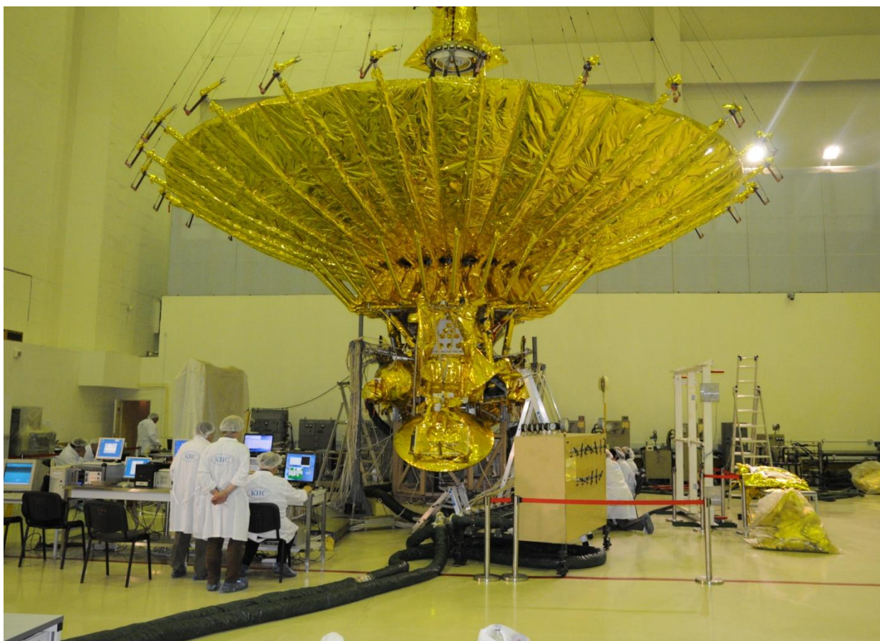
Рисунок 3. Комплексные испытания КРТ с космической платформой (базовым модулем) «Навигатор», рефлектор раскрыт. (НПО им. С.А. Лавочкина, июнь 2011 г.)
