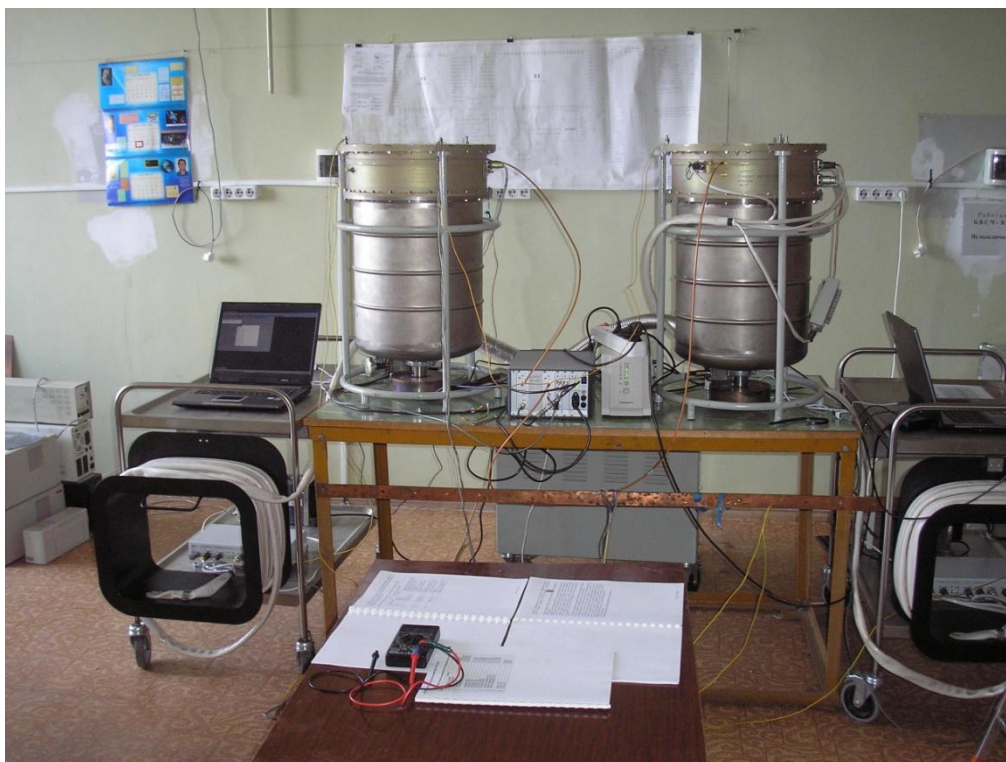
Рисунок 5. Водородные стандарты частоты (мазеры), разработанные для проекта «Радиоастрон» в ЗАО «Время-Ч» (Нижний Новгород)
