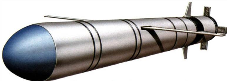
Тактическая (оперативно-тактическая) крылатая ракета 3М-143, Россия. Класс «море—земля». Стартовая масса — 1 690 кг, длина — 6,2 м. Дальность пуска — 300 км, высота полета — 20—150 м. Боевая часть — обычная
