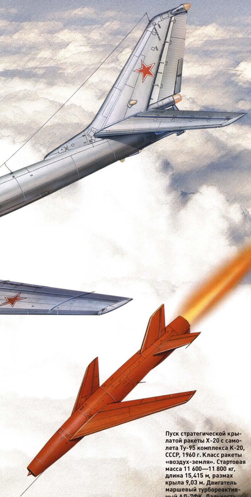
Пуск стратегической крылатой ракеты X-20 с самолета Ту-95 комплекса К-20, СССР, 1960 г. Класс ракеты «воздух-земля». Стартовая масса 11 600—11 800 кг, длина 15,415 м, размах крыла 9,03 м. Двигатель маршевый турбореактивный АЛ-7ФК. Дальность пуска до 800 км, высота пуска 9—12 км, скорость полета 1850 км/ч
