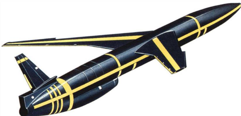
Межконтинентальная крылатая ракета SM-62 «Снарк», США, 1960 г. Класс «земля-земля». Стартовая масса 21 700 кг, длина 22,5 м, размах крыла 14,6 м. Двигатель маршевый турбореактивный J-71. Система наведения: автономная астроинерциальная. Дальность пуска 8 000 км, высота полета до 16 700 м, скорость полета 960 км/ч
