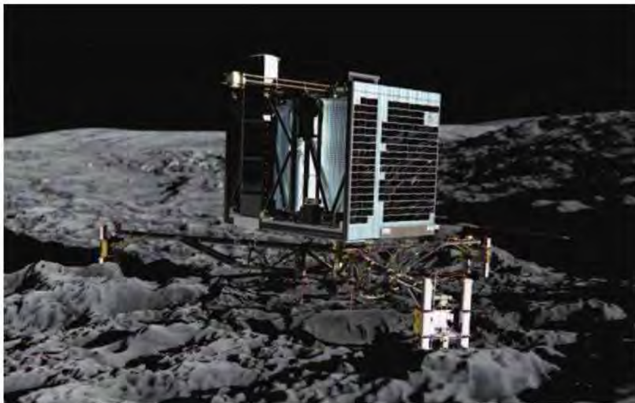
Посадочный модуль «Филы» высадится на поверхность кометы 67P и прикрепится к ней с помощью гарпуна и шурупов; там он пробурит шурф внутрь тела кометы и извлечет керн, а затем проанализирует его состав в своей бортовой лаборатории
