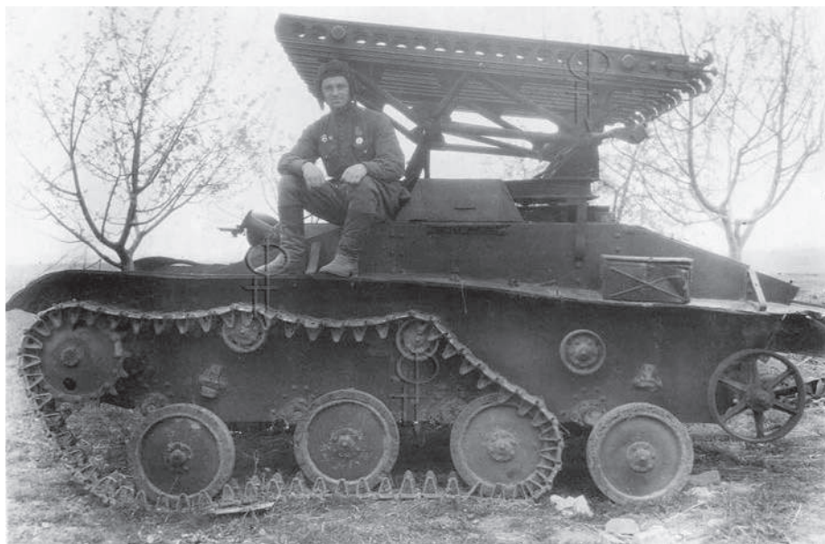
Пусковая установка БМ-8-14 на шасси танка Т-40
