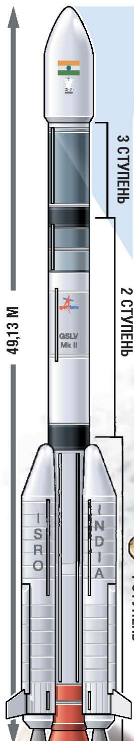
GSLV Mk II (Geosynchronous Satellite Launch Vehicle Mark II — ракета-носитель для запусков геосинхронных спутников)
