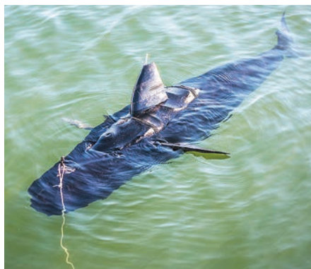
Испытания подводного беспилотника GhostSwimmer
