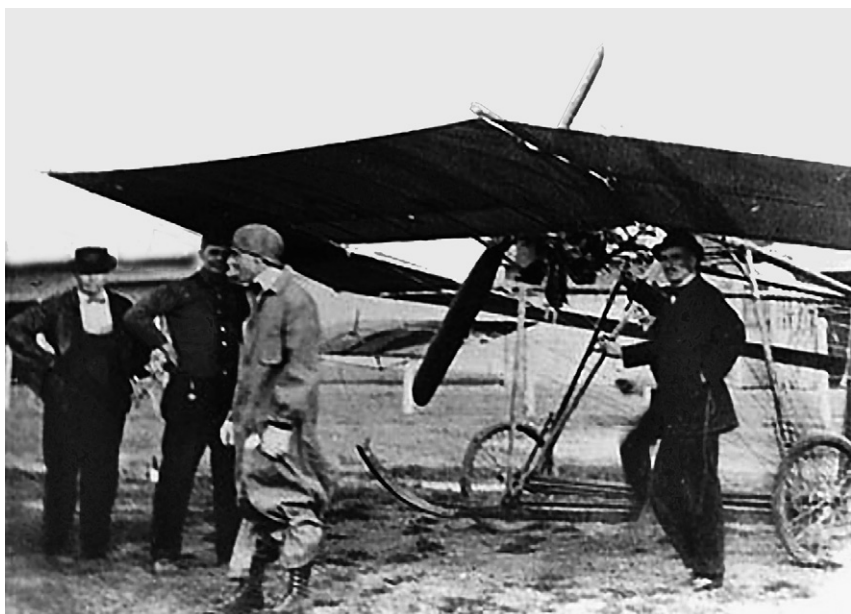
«Зонтик» в Сан-Антонио (пропеллер внутри крыла). Его переделками до 1913 г. занимался Ченс Воут (стоит справа под крылом)
