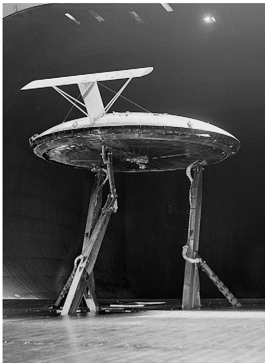
«Аврокар» с хвостовым оперением в АД-трубе
