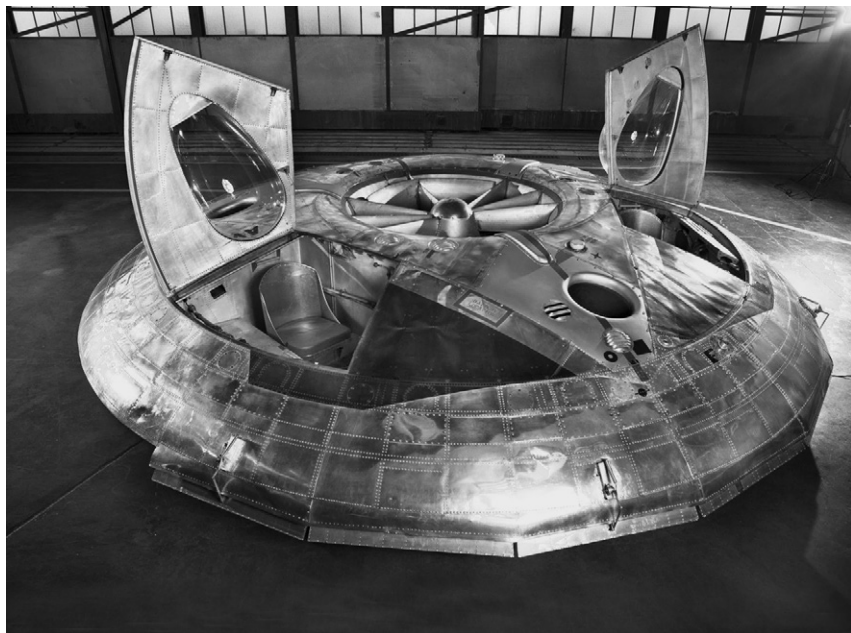
«Аврокар» с двумя кабинами. Фонари кабин подняты
