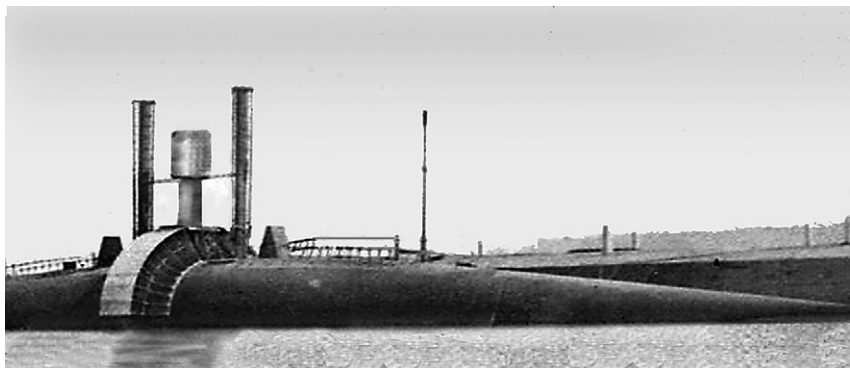
Пароход «Винанс» после перестройки для повышения скорости. В середине появилась рулевая рубка
