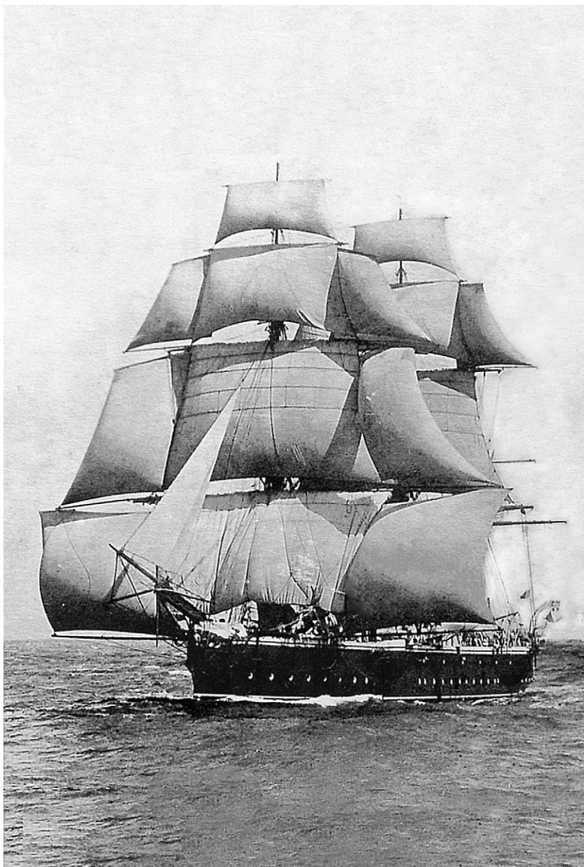
Британский крейсер «Calypso» (2770 т; 16 орудий) вступил в строй в 1883 г. Тем не менее он нёс на двух мачтах с выдвижными реями 4 яруса парусов, и ещё кливер на бушприте
