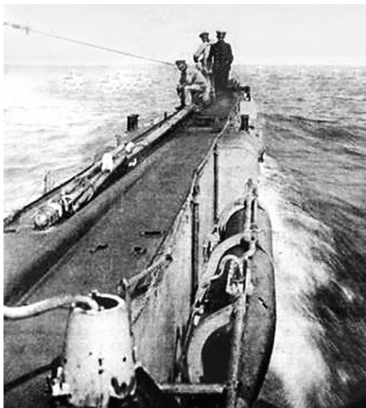
Рамочный торпедный аппарат Джевецкого на российской подводной лодке
