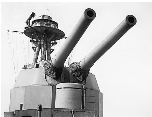
Главный калибр монитора «Terror» (типа «Erebus»). Перед башней – боевая рубка
