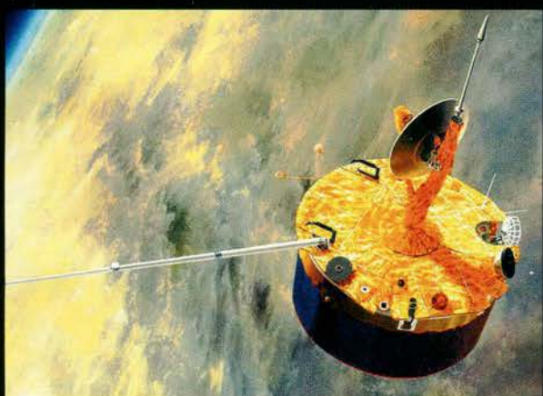
КОСМИЧЕСКИЙ ИССЛЕДОВАТЕЛЬ Орбитальная станция «Пионер» высотой 1,2 м и шириной 2,5 м несла на себе целую батарею приборов, включая магнитометр на конце штанги длиной 4,7 м, который должен был охарактеризовать магнитное поле планеты.
