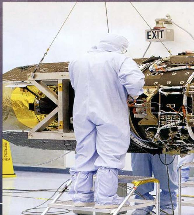
GALEX – это платформа с трехосевой стабилизацией (см. «Глоссарий»). Система полностью автономна и рассчитана на контроль только бортовых систем. Двигателей малой тяги для регулирования ориентации аппарата в космосе нет, вместо этого используются четыре реактивных колеса.
