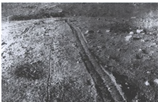
Фрагмент панорамы, полученной с «Лунохода-2». Тонкая полоса в середине колеи — след от колеса, с помощью которого определялось пройденное расстояние
