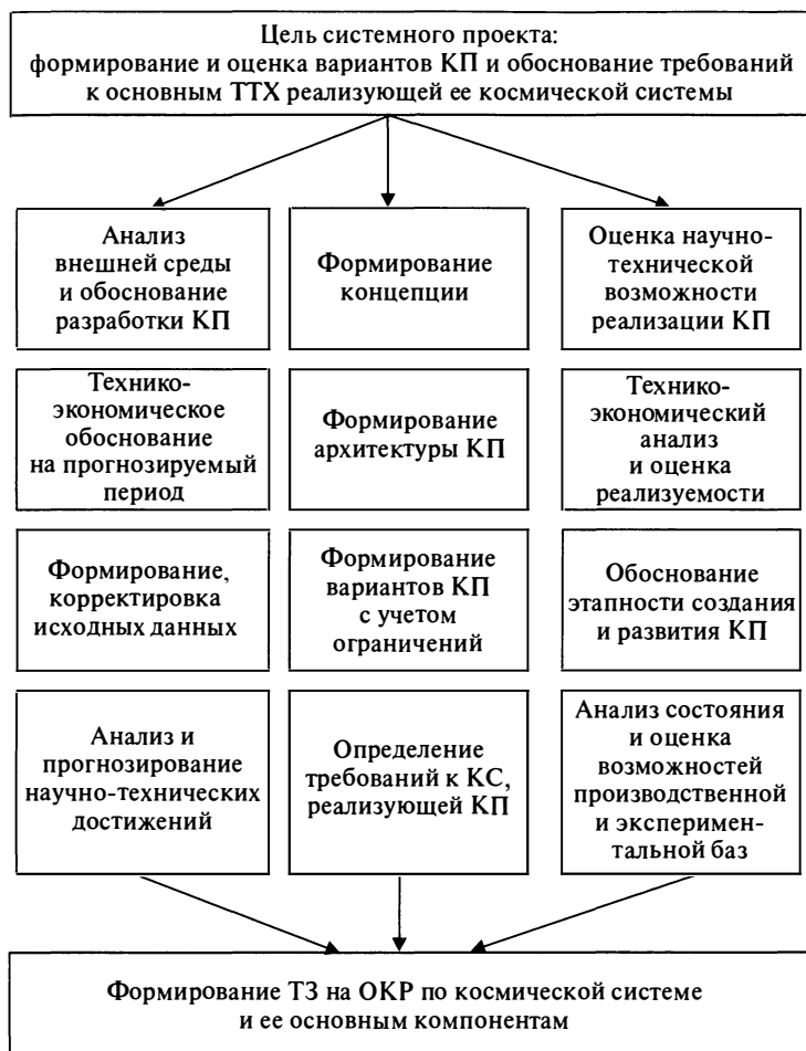
Рис. 6.5. Содержание основных работ системного проектирования: ТТХ — тактико-технические характеристики; КП — космическая программа; КС — космическая система; ОКР — опытно-конструкторские работы
