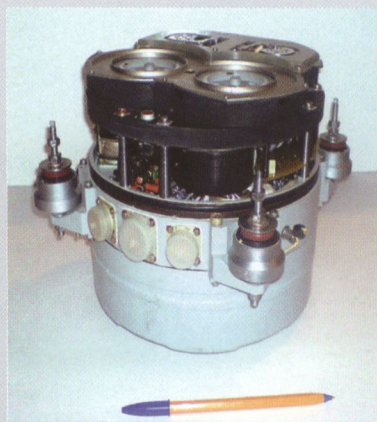
ЭА025М. Ленточное многоско- ростное запоминающее устрой- ство, для бортовых ТМ-систем кос- мических пилотируемых аппара- тов «Союз», «Прогресс», МКС «Буран» и ТМ-систем КА серии «Космос», 1980 г.
