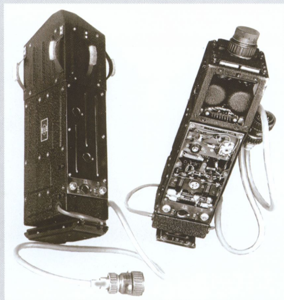
Д-200. Передатчик первого искусственного спутника Земли. Разработан в 1956 г.
