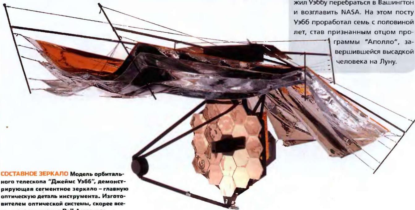
**СОСТАВНОЕ ЗЕРКАЛО** Модель орбитального телескопа “Джеймс Уэбб”, демонстрирующая сегментное зеркало – главную оптическую деталь инструмента. Изготовителем оптической системы, скорее всего, станет компания Ball Aerospace
