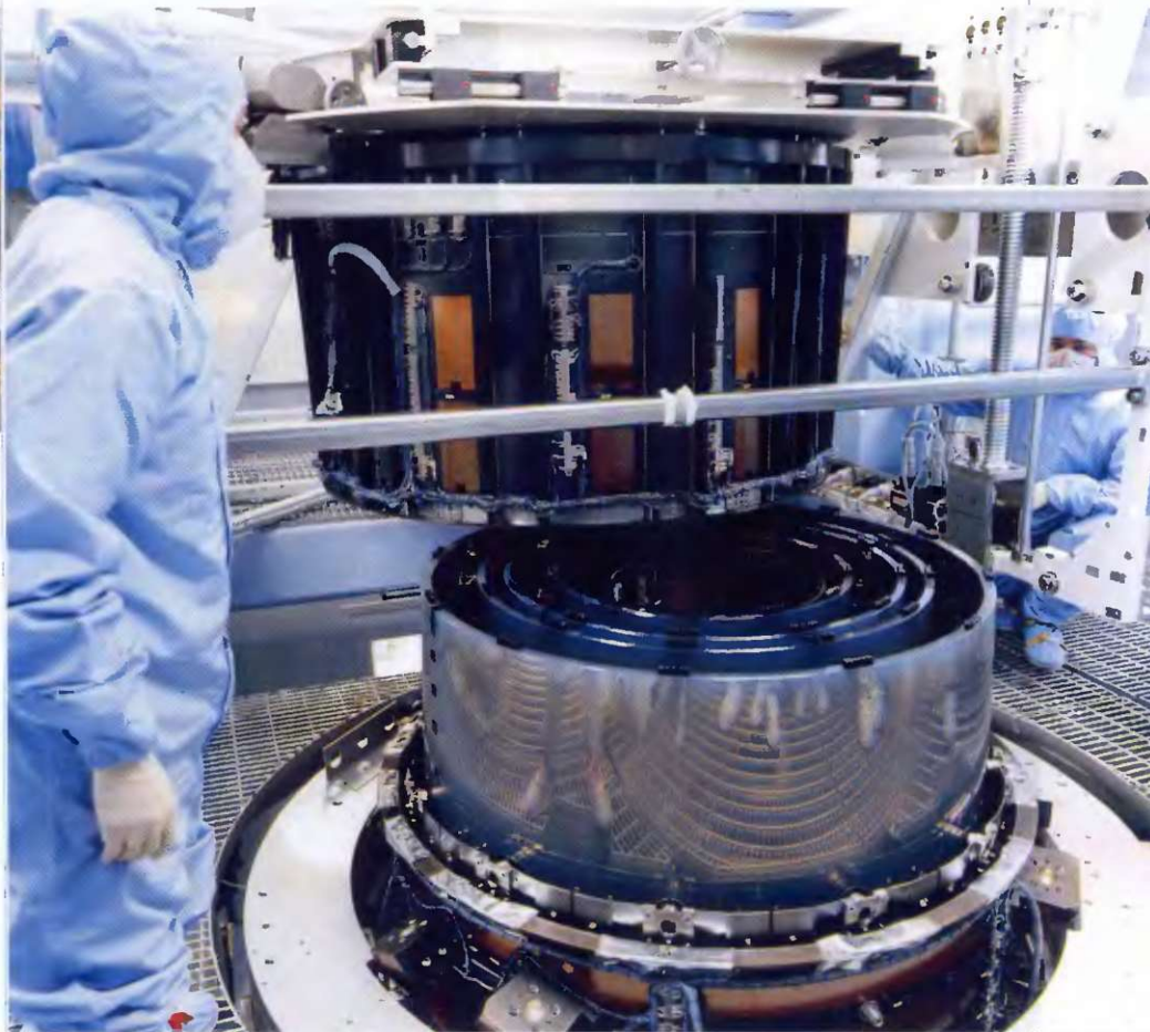
РЕНТГЕНОВСКАЯ РАДУГА Вверху: рентгеновский дифракционный спектрометр высокого разрешения LETGS – набор золотых дифракционных решеток с периодом в 1 мкм. Справа: сборка главного зеркала
