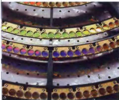
РЕНТГЕНОВСКАЯ РАДУГА Вверху: рентгеновский дифракционный спектрометр высокого разрешения LETGS – набор золотых дифракционных решеток с периодом в 1 мкм. Справа: сборка главного зеркала
