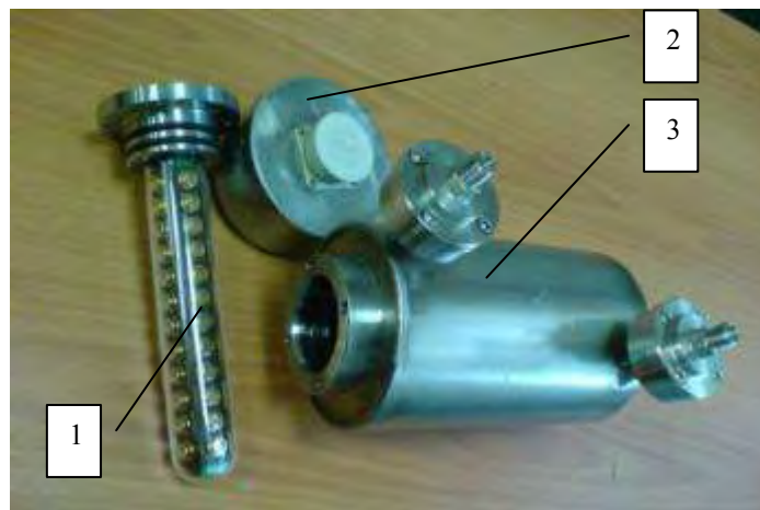
Рис. 7. Составные части УС: 1 – излучатель; 2 – блок питания; 3 – корпус реактора
