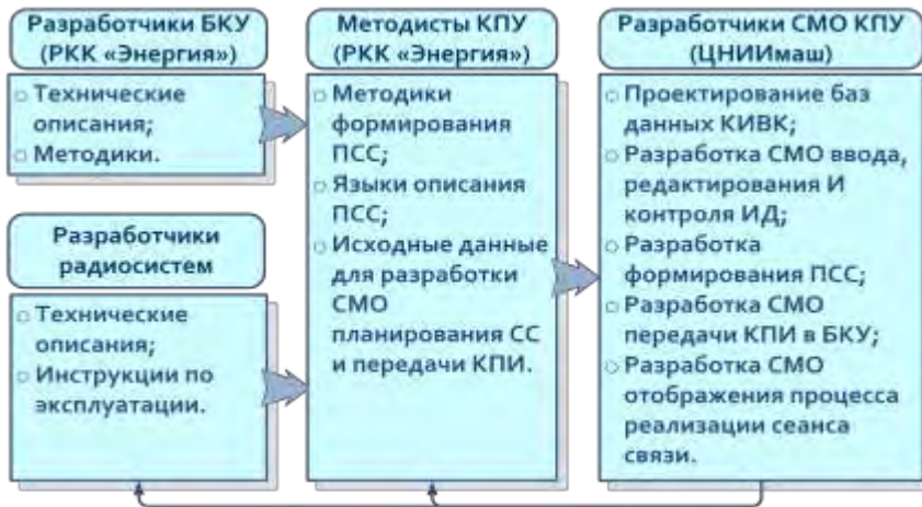
Рис. 12. Подготовка СМО передачи КПИ в БКУ (КИВК – командно-информационный вычислительный комплекс; ПСС – план сеанса связи (СС); ИД – исходные данные)
