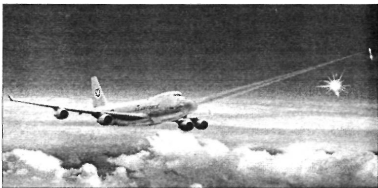
Самолет-носитель лазерной установки противоракетной установки «YAL-1A» в действии
