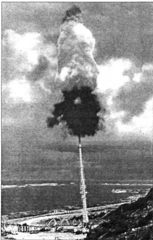
Суборбитальный запуск с использованием 406-миллиметровой пушки программы «HARP»
