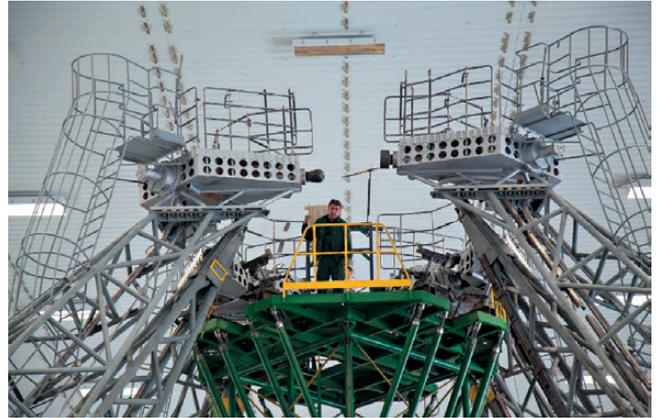
▲ А вот так проводили испытания ферм стартового комплекса на «Тяжмаше» перед отправкой на Восточный
