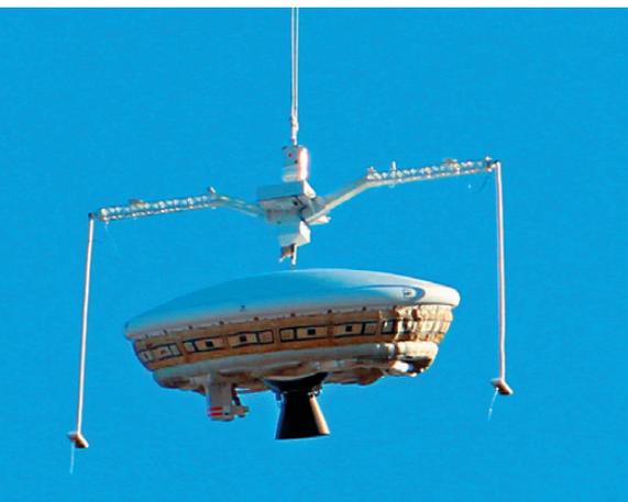
8 июня в 11:35 по местному времени (21:35 UTC) на полигоне ВМС США на острове Кауаи (Гавайские о-ва) состоялся второй запуск «летающей тарелки» – сверхзвукового тормозного устройства низкой плотности LDSD (Low-Density Supersonic Decelerator), принадлежащего NASA. Аппарат в виде конуса с большим углом полураскрытия, в центральной части которого был закреплен твердотопливный разгонный двигатель, начал свой самостоятельный полет с высотного аэростата.
