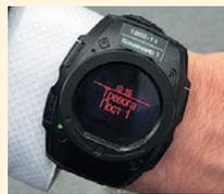
Охранный комплекс «Стрелец» представляет собой браслет на руке часового, связанный с командным пультом. Встроенный модуль ГЛОНАСС позволяет следить за перемещениями вооруженного караульного. Браслет подает сигнал вибрацией и на пульт, если часовой покинет определенную ему зону или останется без движения более 40 секунд.
