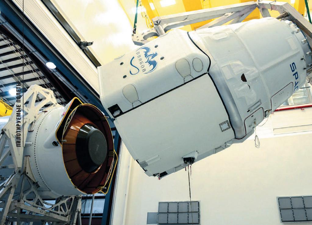
▲ По одной из высказанных версий, стыковочный адаптер IDA-1, закрепленный в грузовом отсеке «Дракона» (справа), мог оторваться в полете и ударить по верхней части второй ступени, разрушив бак
