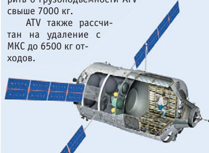
Во втором полете европейского грузовика в модуле EPM были установлены восемь стандартных грузовых стоек для перевозки сухих грузов. В каждой из них были предусмотрены два отсека объемом 0.314 м<sup>3</sup> и два отсека объемом 0.414 м<sup>3</sup>. Таким образом, общий объем сухих грузов, который мог быть размещен в ATV-2, составлял 11.648 м<sup>3</sup>. Все сухие грузы, включая еду, запчасти, инструменты, одежду, предметы личной гигиены, компьютеры, были упакованы в специаль-
