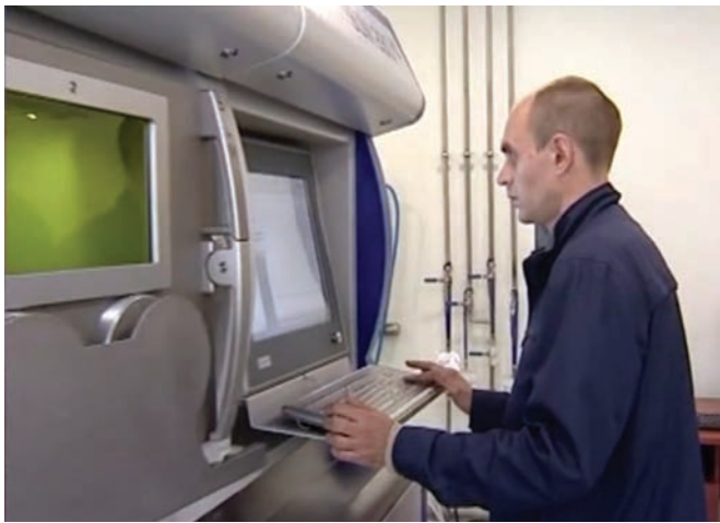
Рис. 11. Установка селективного лазерного плавления SLM 280 в «КБ «Южное»
