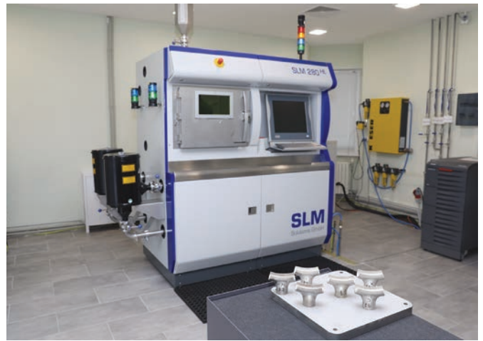
Рис. 11. Установка селективного лазерного плавления SLM 280 в «КБ «Южное»
