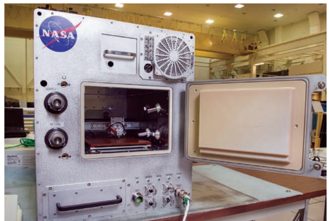
Рис. 3. Рефабрикатор способен перерабатывать и печатать (имеется в виду 3D-печать) с использованием космического пластика ULTEM. Изображение предоставлено NASA / MSFC / Emmett Given
