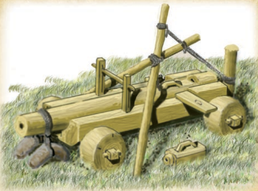
Деревянная пушка со съемной зарядной камерой и простейшим противоткатным устройством
