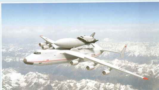
Многоцелевая авиационно-космическая система (МАКС), разработанная НПО «Молния». Иллюстрация buran.ru
