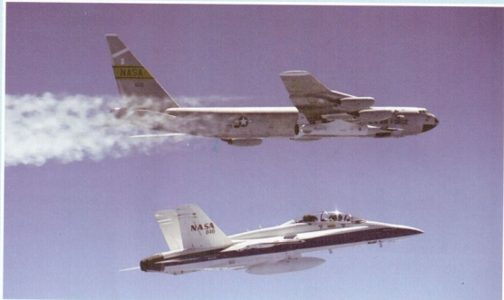
Ракетоплан X-43A с разгонным блоком ракеты «Пегас» под крылом носителя B-52B
