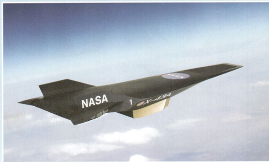
Первый вариант беспилотного экспериментального гиперзвукового аппарата X-43A. Установлен рекорд скорости в 12144 км/ч (Мах 9,8)
