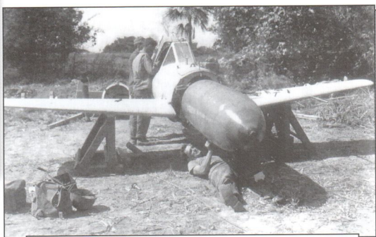
Американские техники демонтируют боеголовку с трофейного самолета-снаряда МХУ7 «Ока» Модель 11
