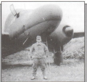
Самолет для атак камикадзе Ki 67-1-KAI «То-Го» переоборудовался из строевых бомбардировщиков «Хирию» путем установки термитной бомбы в носовой части
