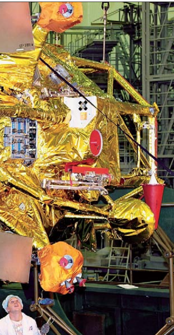
Перелётный модуль с возвращаемым аппаратом и переходной фермой.
