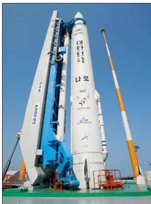
Ракета KSLV-1. Южная Корея использовала универсальный модуль российской «Ангары» в качестве первой ступени своей ракеты.
