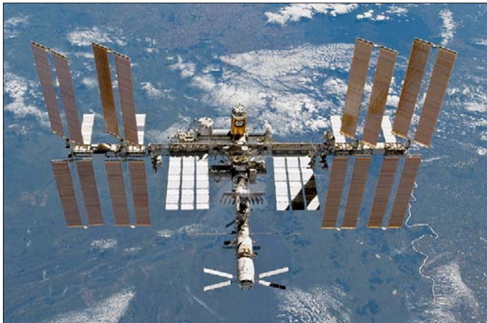
МКС. С российским модулем «Звезда» состыкован европейский «грузовик» ATV-2 «Иоганн Кеплер».
