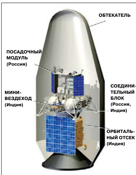
Аппарат «Луна-Глоб» в головной части ракеты-носителя. Рисунок: НПО им. С. А. Лавочкина.
