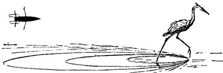
Цапля движется с такой же скоростью, как и волна. Гребни волн соединяются в один волновой гребень. Когда тело движется со скоростью звука, волны не могут обогнать тело, и образуется ударная волна — волна сжатого воздуха, которая движется вместе с телом.
