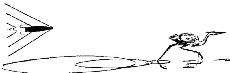
Цапля движется быстрее, чем распространяется волна. Она обгоняет волну. Когда тело движется быстрее звука, то порождаемые им волны отстают от него и, складываясь, образуют сзади него коническую волну.
