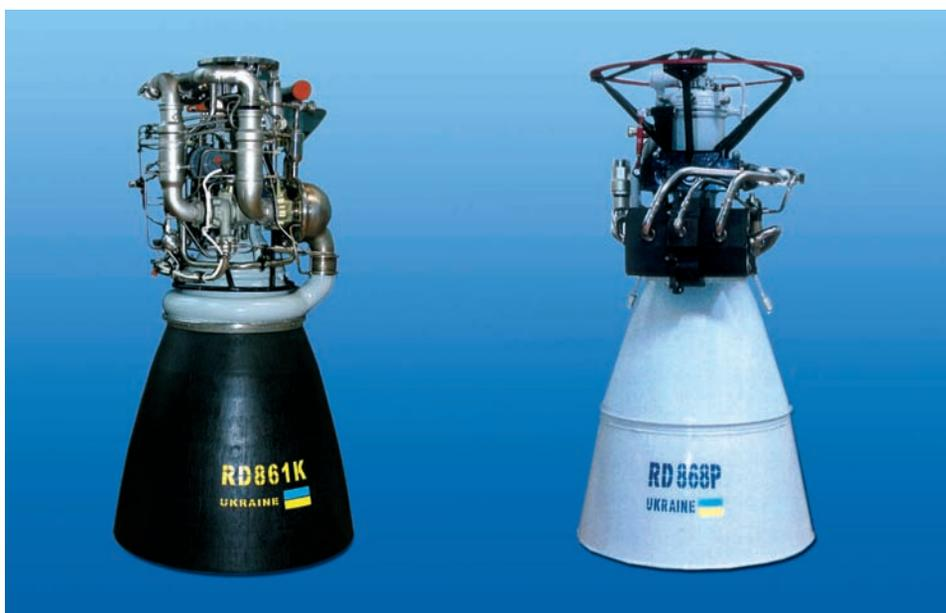
**Жидкостные ракетные двигатели разработки КБ «Южное»**
