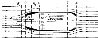
Рис. 29. Принципиальная схема ПВД для дозвуковых скоростей с цилиндрической камерой сгорания
