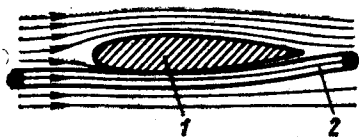
Рис. 3. Трубка тока частиц воздуха: 1 — обтекаемое тело; 2 — струйка — трубка тока частиц воздуха
