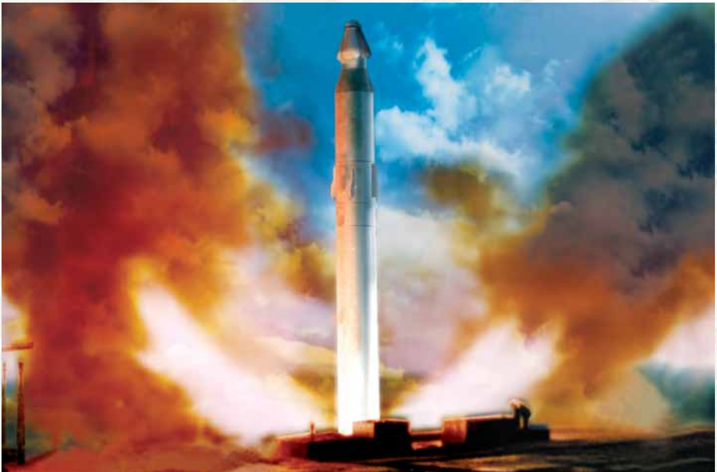
Газодинамический старт из ШПУ межконтинентальной ракеты Р-36 с разделяющейся головной частью
