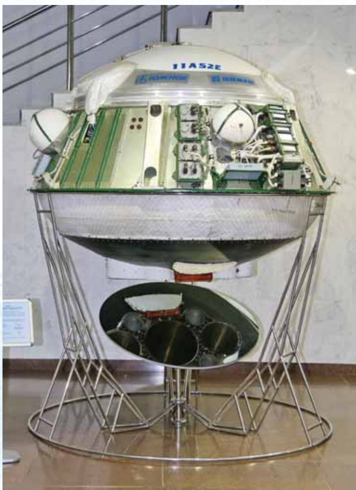
Взлетно-посадочный модуль лунного корабля (блок Е)
