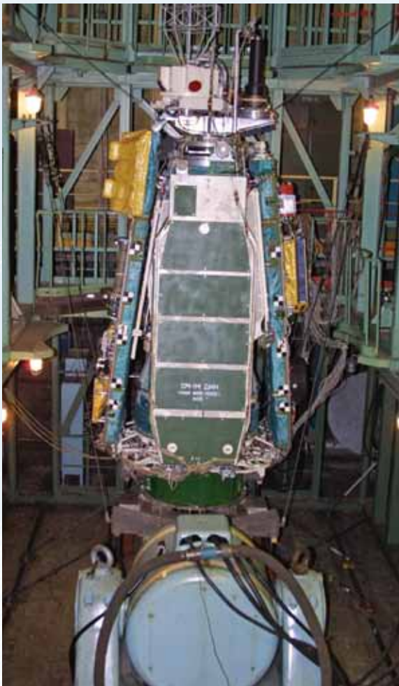
Вибрационные испытания космического аппарата «Сич-1М»
