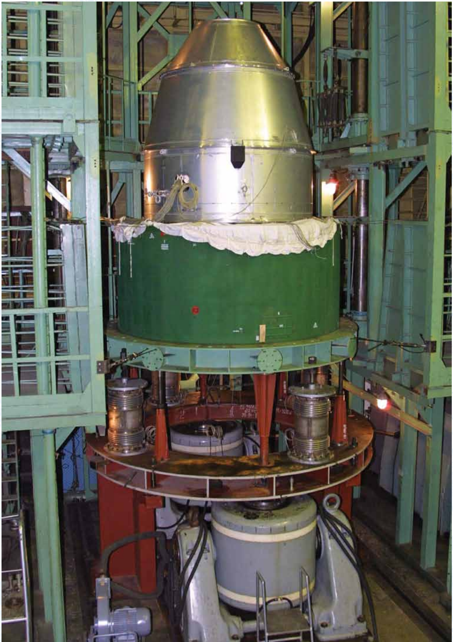
Вибрационные испытания модуля полезной нагрузки РН «Днепр»
