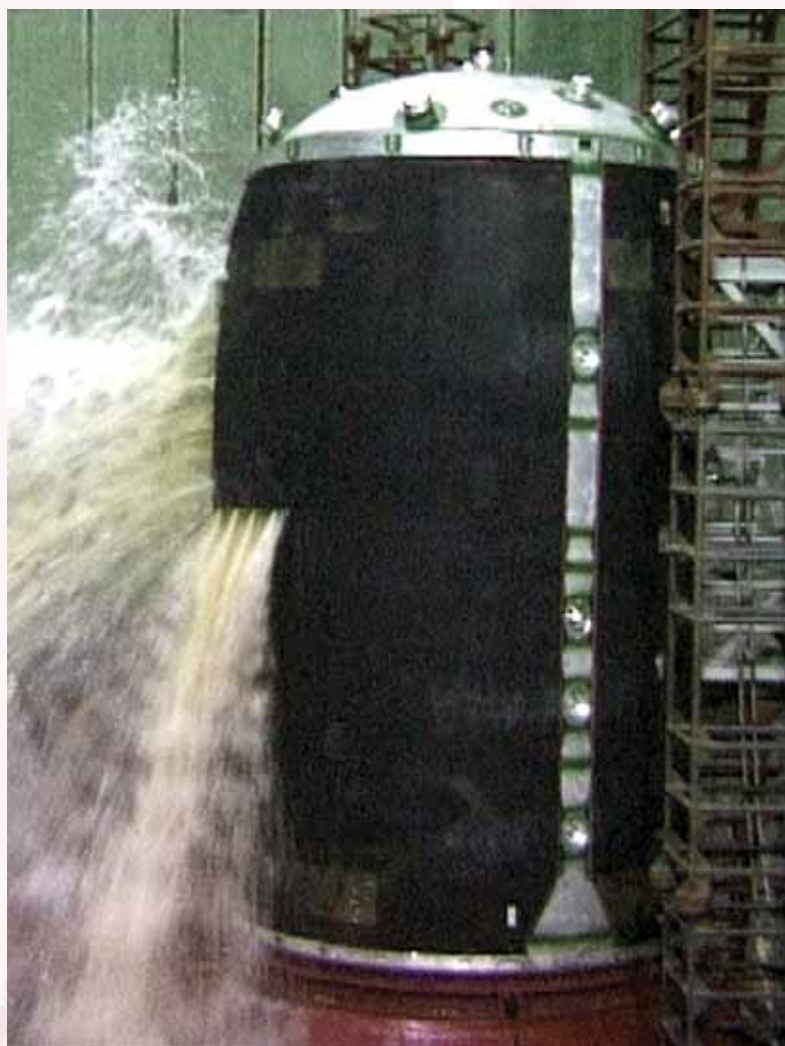
Нагружение бака ракеты Р-36М2 (15А18М) внутренним давлением до разрушения
