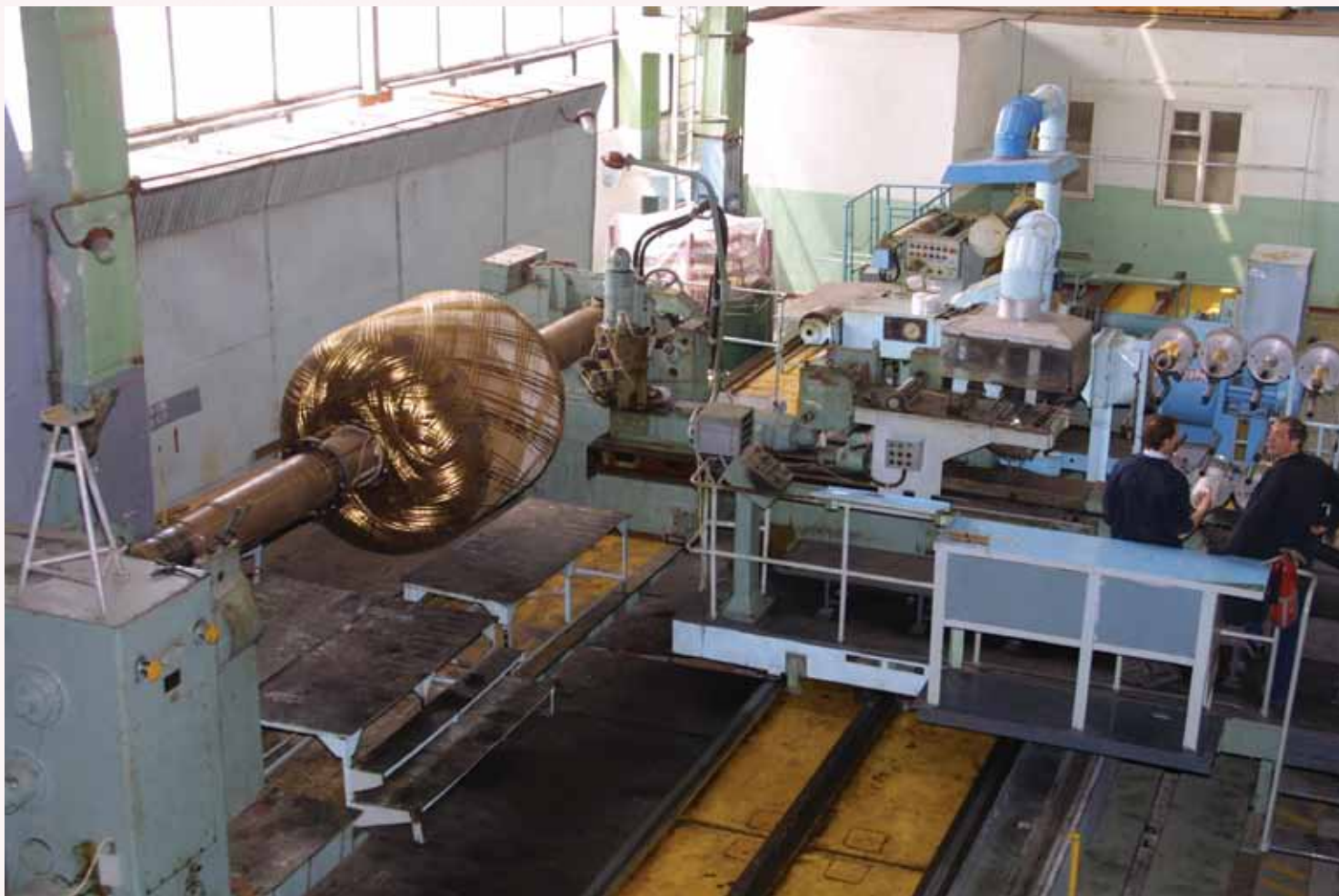
Изготовление корпуса РДТТ из полимерных композиционных материалов методом намотки
