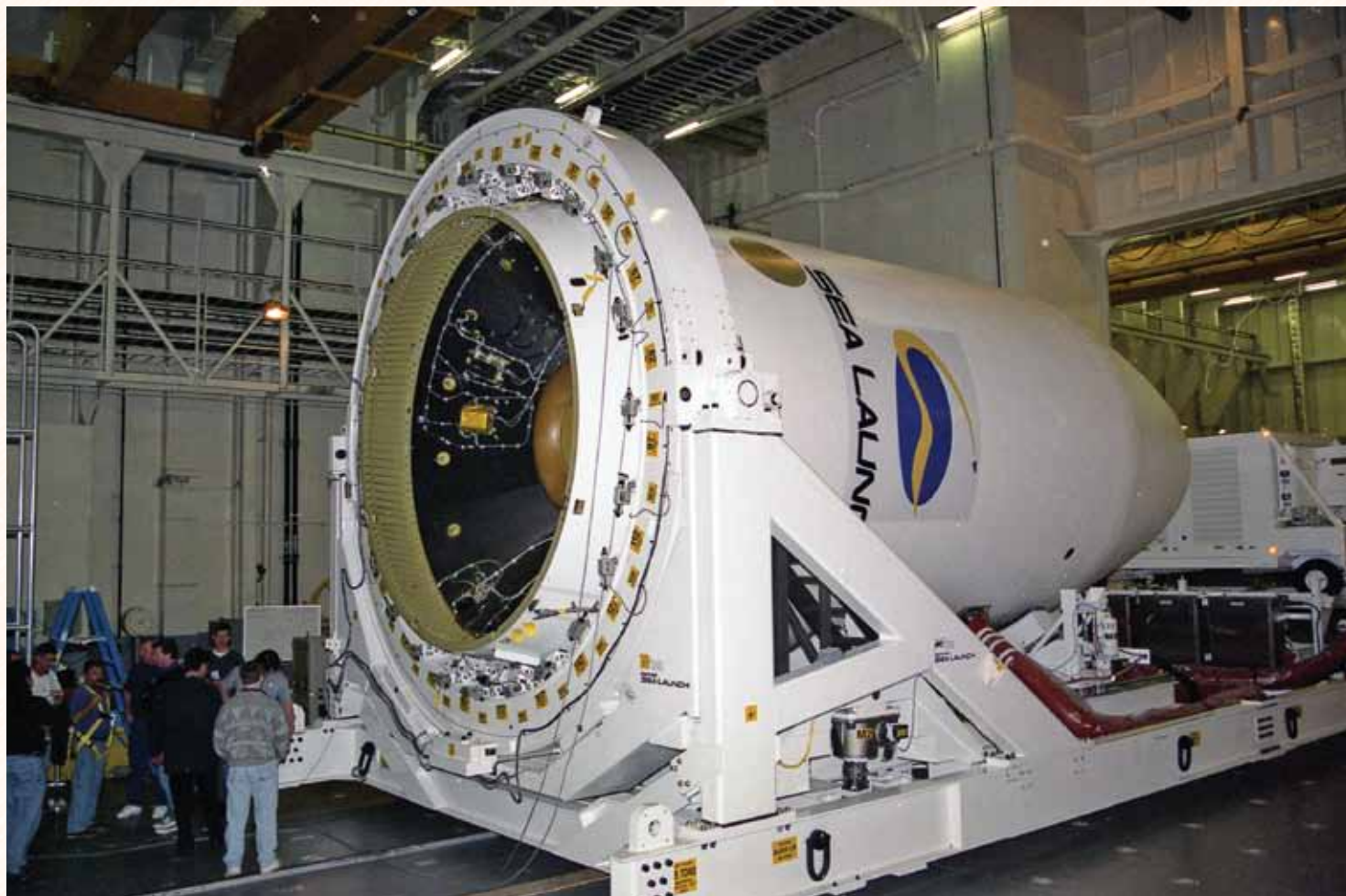
Блок полезного груза РН «Зенит-3SL» в монтажно-испытательном зале на сборочно-командном судне
