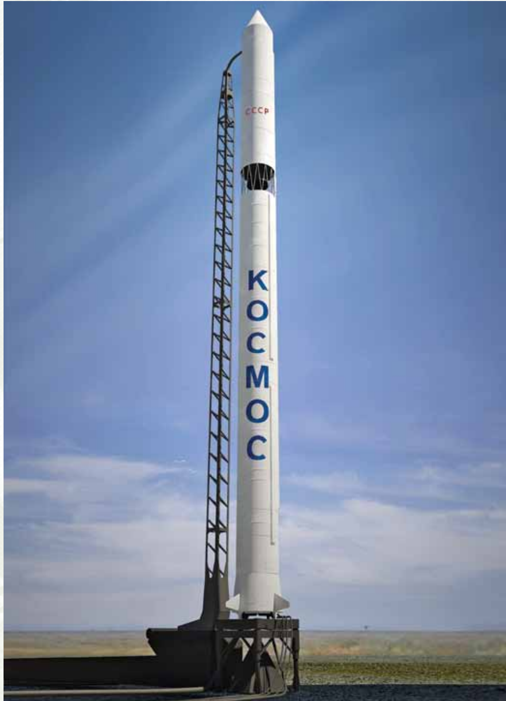
Первая ракета-носитель «Космос» (11K63), разработанная в ОКБ-586 на базе ракеты Р-12
