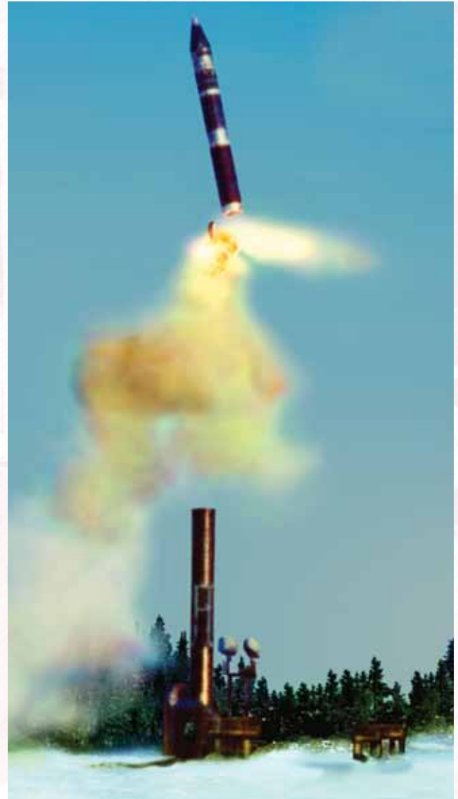
Отличительной особенностью старта ракеты РТ-23 железнодорожного базирования стал принудительный заклон ракеты, выполнявшийся для снижения газодинамического воздействия струи маршевого двигателя на БЖРК
