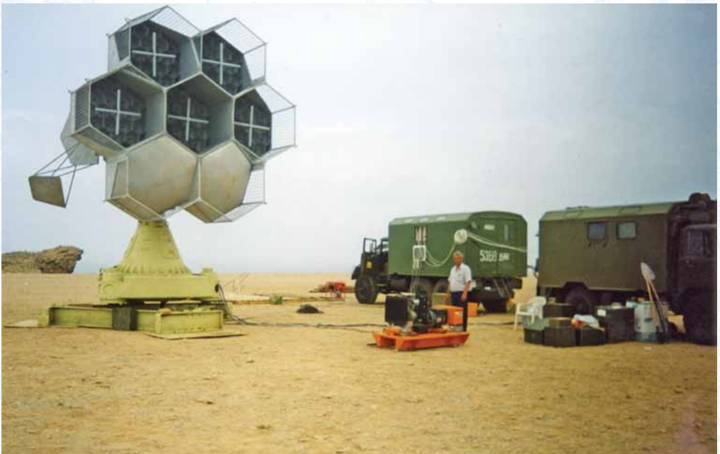
ВИП используется для определения параметров отделения КА от ракеты-носителя и получения телеметрической информации
