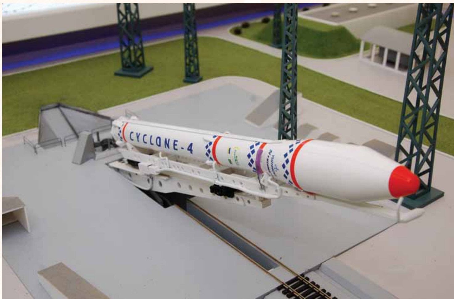
Модель подъемно-установочного агрегата РН «Циклон-4»
