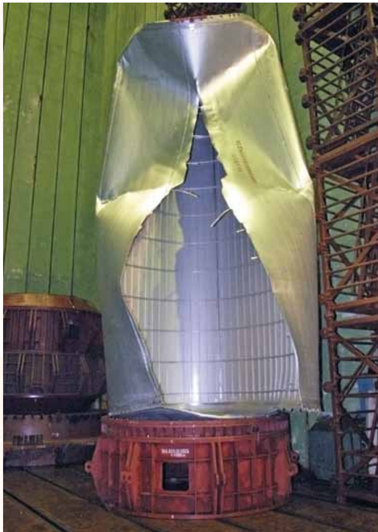
Бак окислителя РН «Циклон-4» после испытаний внутренним давлением до разрушения
