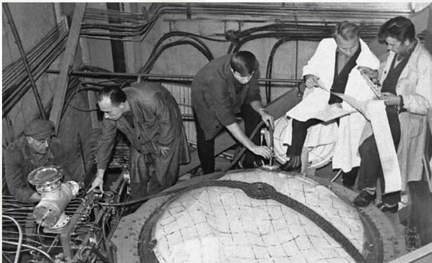
Подготовка испытаний системы перелива бака окислителя ракеты
