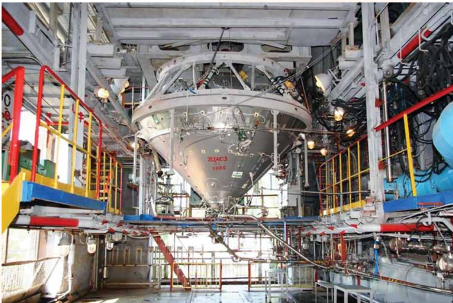
Топливный отсек третьей ступени РН «Циклон-4»
