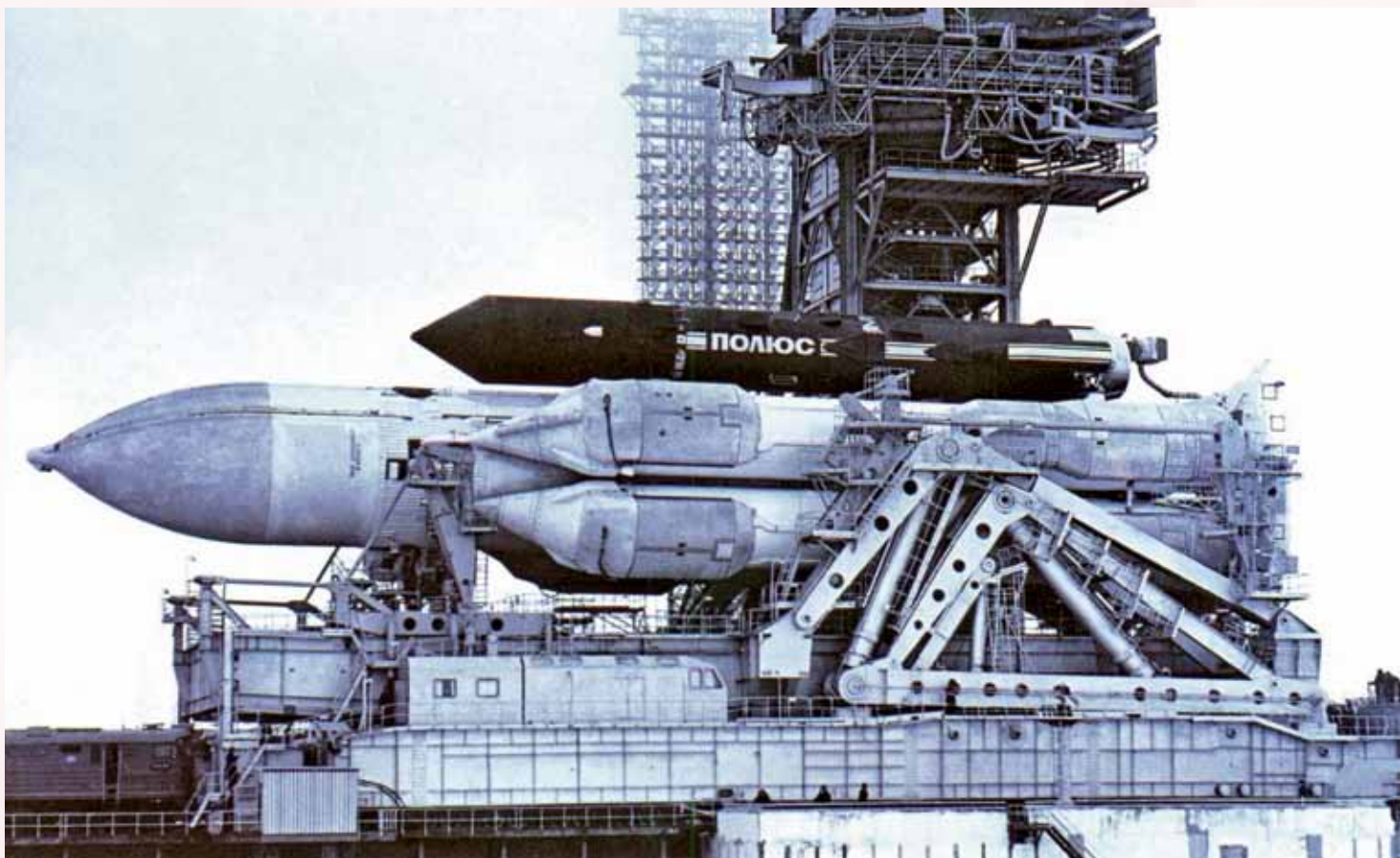
Транспортировка ракеты-носителя «Энергия» с кораблем «Скиф-19ДМ» («Полюс») на стартовый комплекс, май 1987 года
