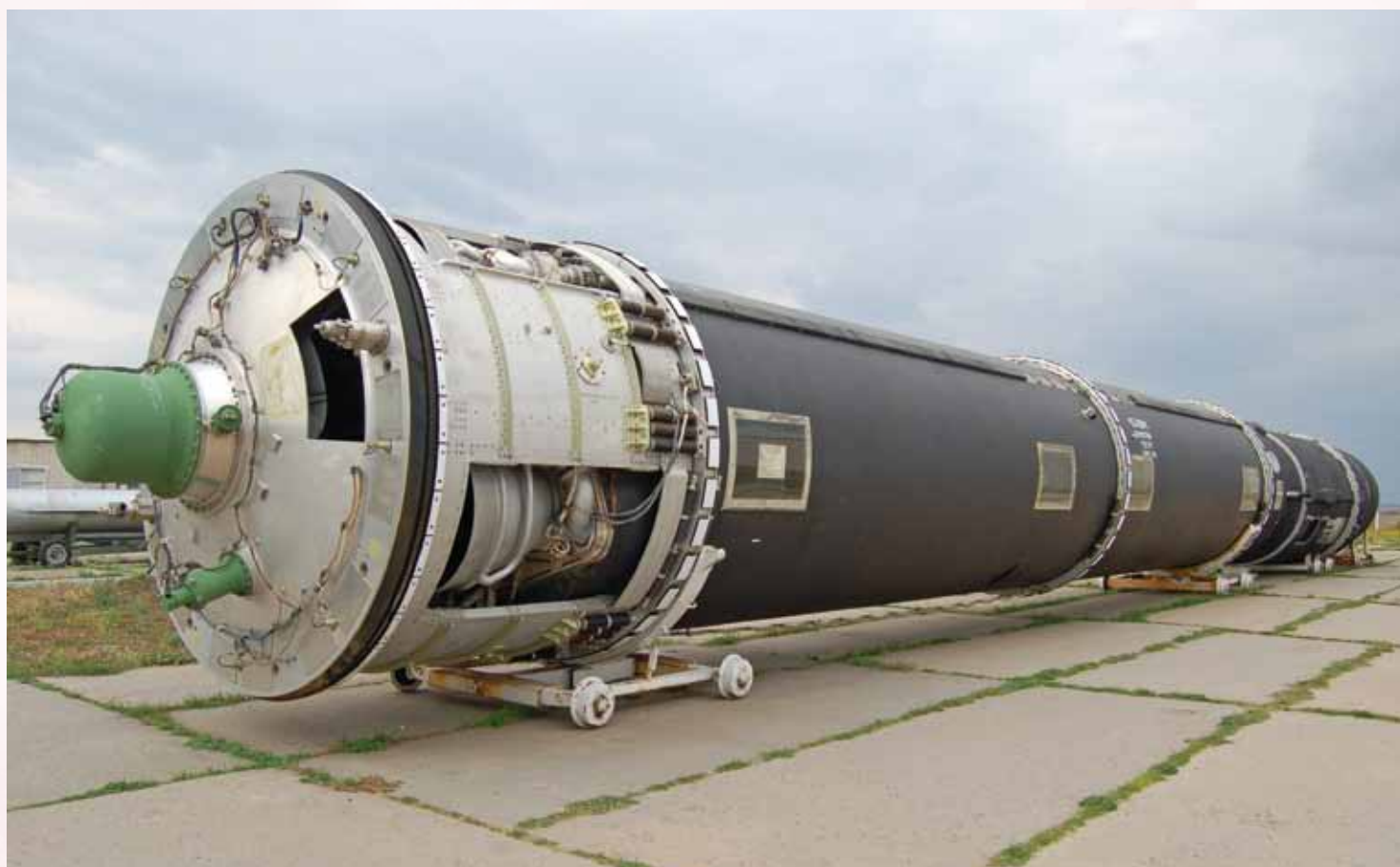
Хвостовая часть ракеты Р-36М2 с пороховым аккумулятором давления
