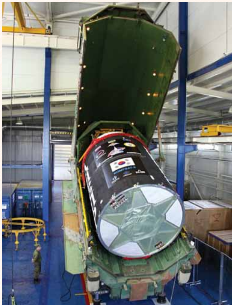
Головная часть РН «Днепр» с южнокорейским КА Д33 Kompsat-5 в монтажно-испытательном корпусе в Ясном, август 2013 года
