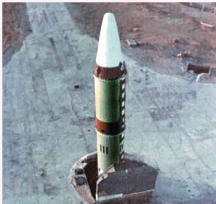
Бросковые испытания БИ-4 ракеты Р-36М (15А14) на полигоне Байконур, 1972 год
