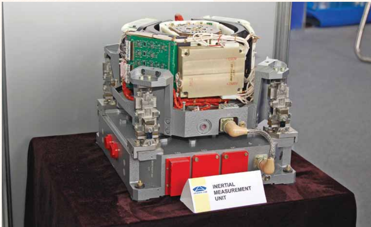
Бесплатформенная инерциальная навигационная система (БИНС) для системы управления РН «Циклон-4»
