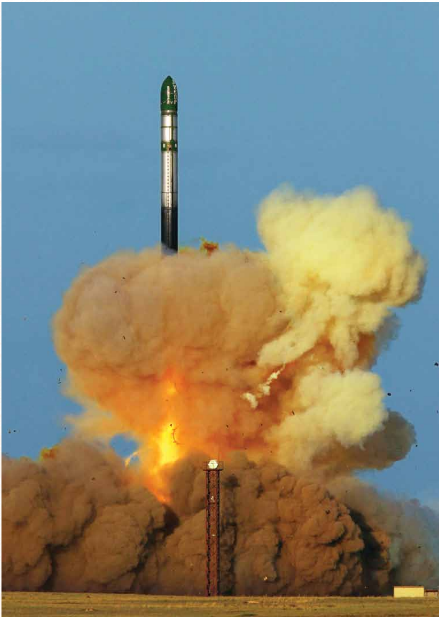
21 ноября 2013 года, 19-й раз в рамках программы «Днепр», с пусковой базы в Ясном осуществлен пуск РН «Днепр» с КА восьми стран-заказчиков. РН «Днепр» создана на базе конверсионной ракеты Р-36М УТТХ (15А18)
