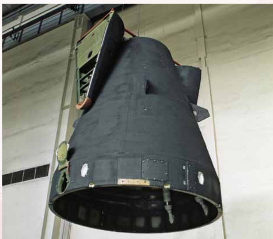
На ракете РТ-23 шахтного базирования применялся складной головной обтекатель, створки которого закрывались после выхода ракеты из транспортно-пускового контейнера
