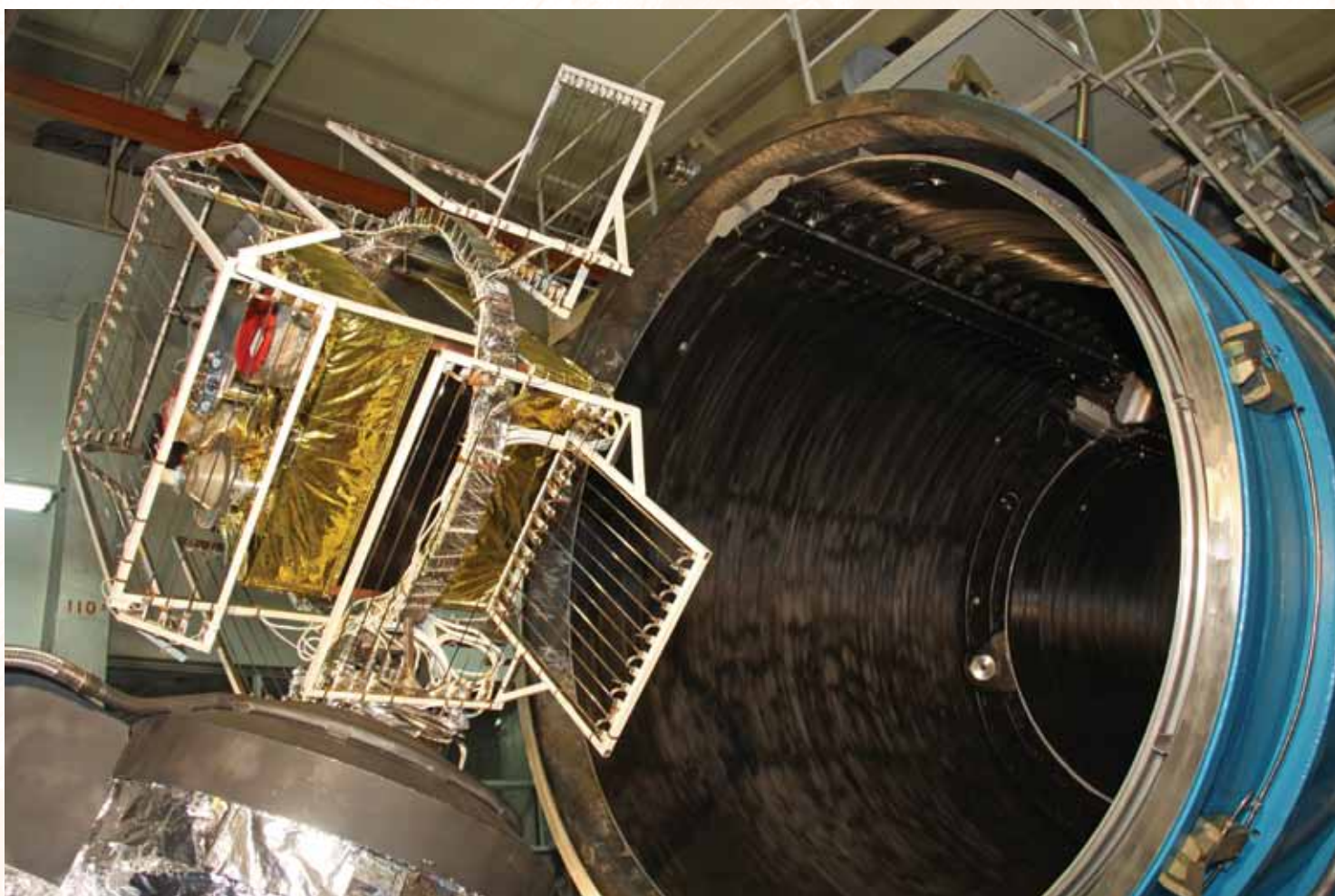
Перед началом термовакuumных испытаний КА «Сич-2»
