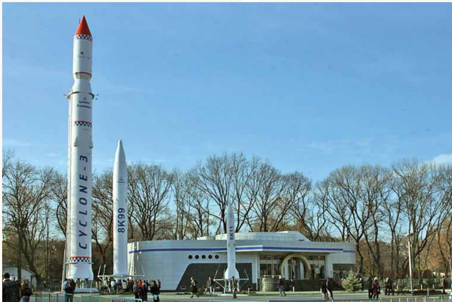
Экспозиция ракет, созданных в разные годы в Днепропетровске: Р-11 (8К11) – одна из первых советских баллистических ракет, РТ-20П (8К99) – первая ракета с мобильным стартом, ракета-носитель «Циклон-3» (11К68)
