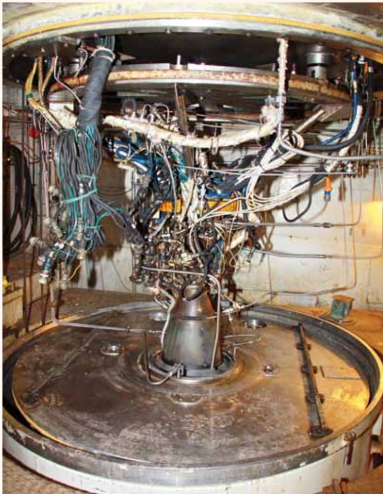
Подготовка к огневым испытаниям на стенде двигателя верхней ступени РН «Вега»
