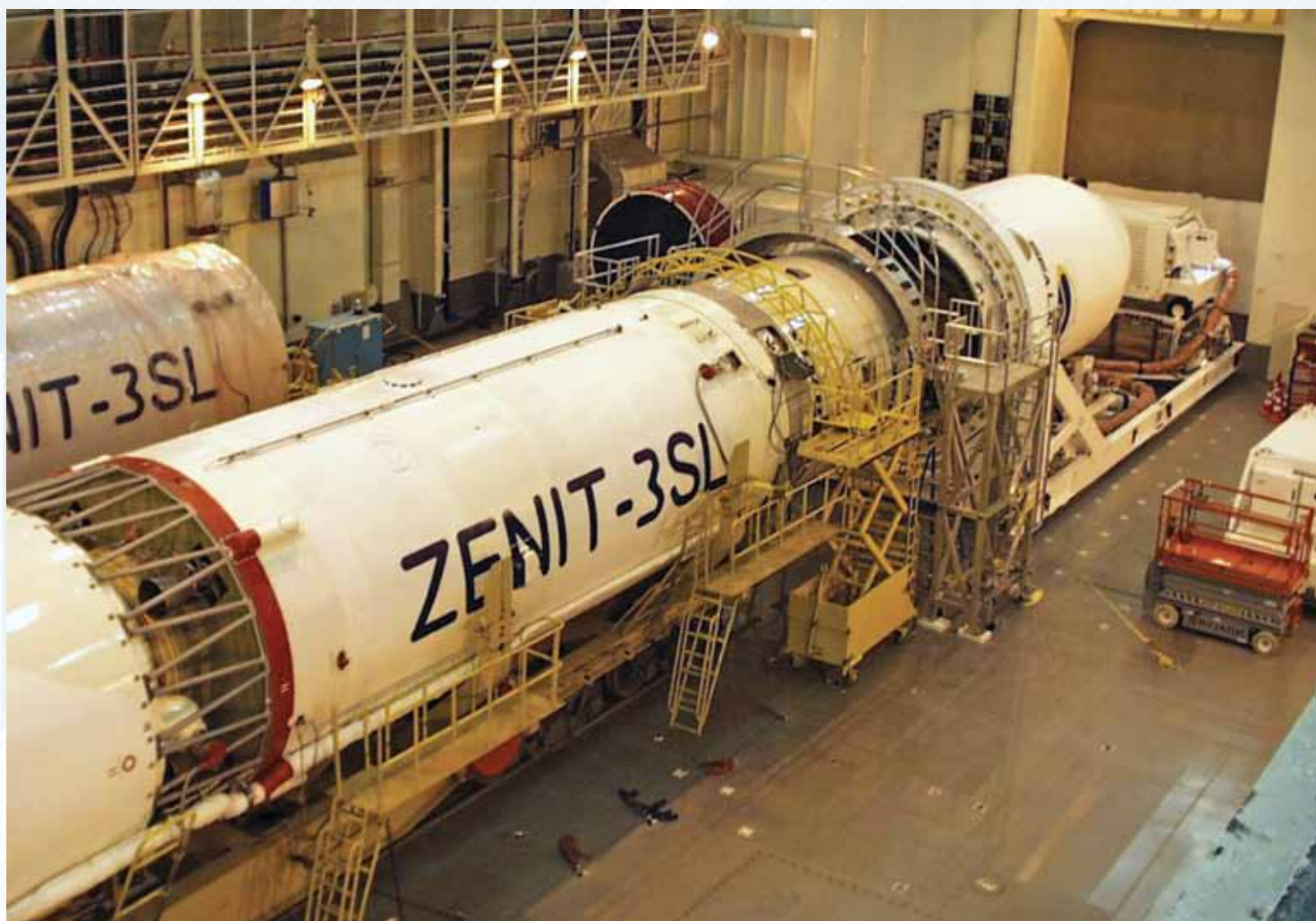
Сборка ракет-носителей «Зенит-3SL» в монтажно-испытательном зале на сборочно-командном судне
