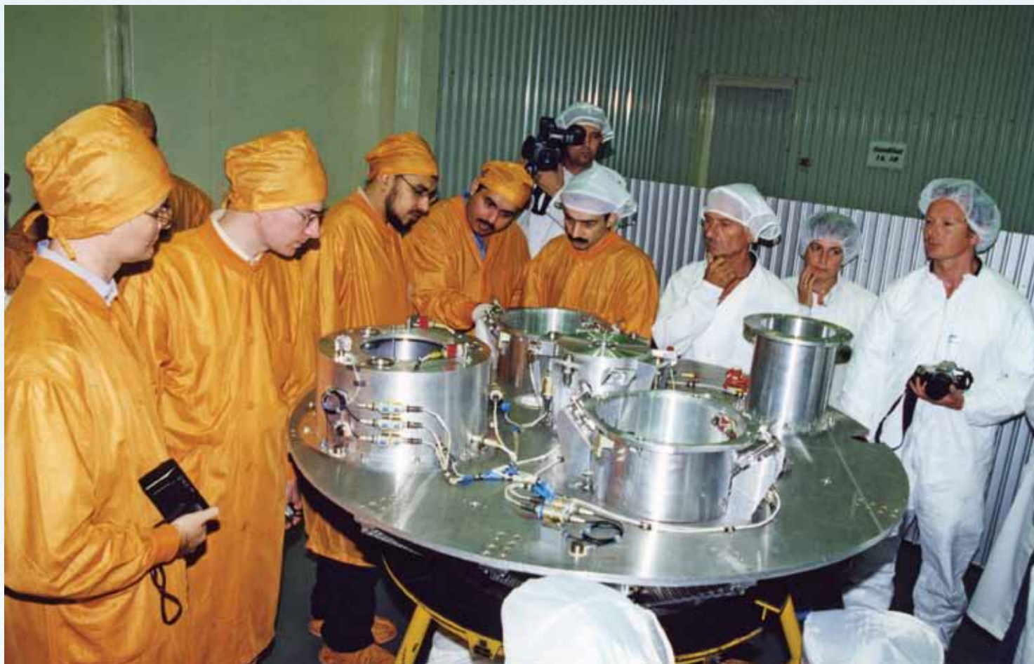
Платформа модуля полезной нагрузки РН «Днепр», куда будут устанавливаться космические аппараты
