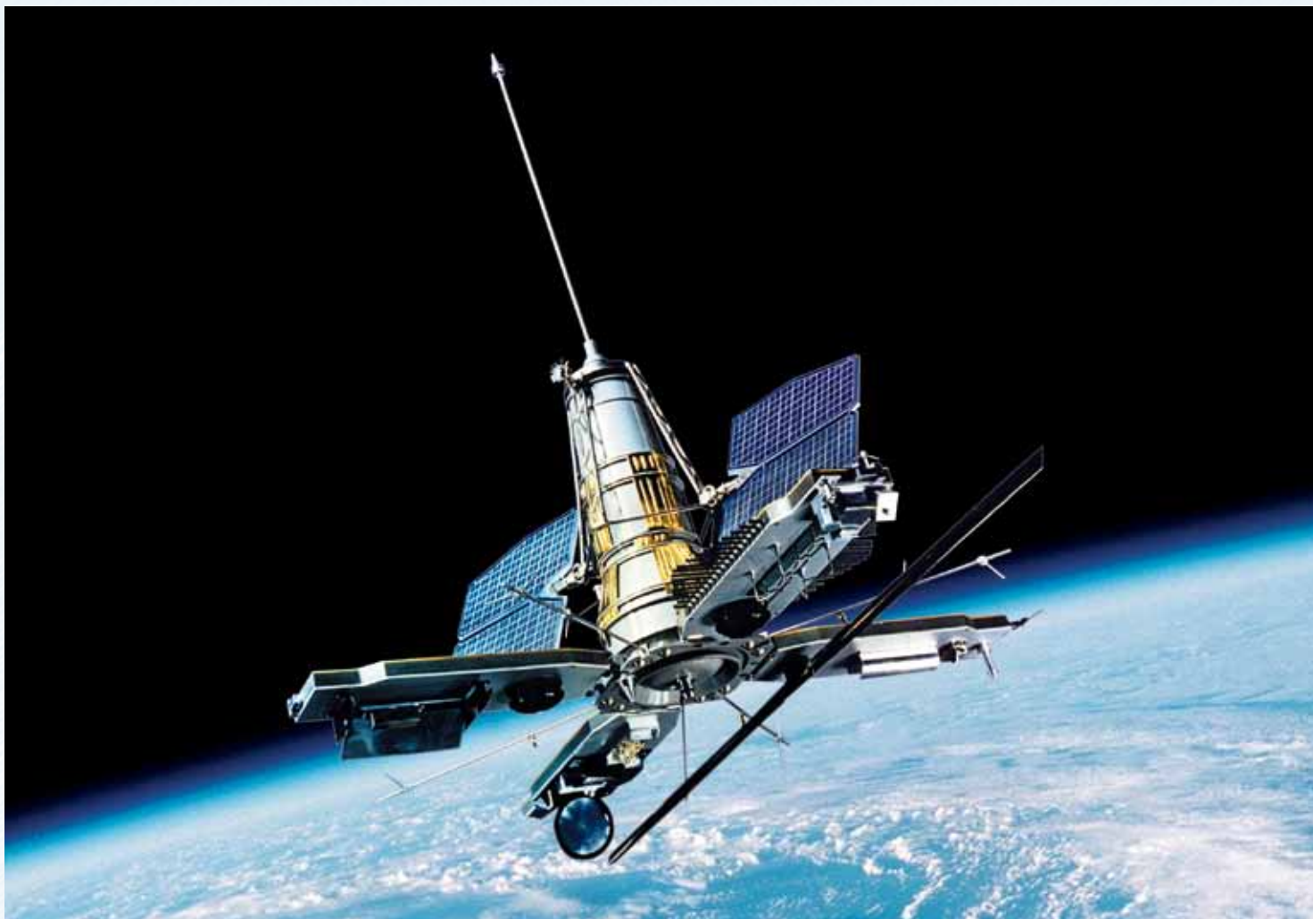
Первый украинский космический аппарат «Сич-1», предназначенный для дистанционного зондирования Земли
