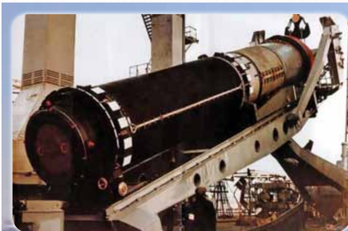
Твердотопливная морская ракета РСМ-52 с двигателем 1-й ступени ЗД65, разработанным в КБ «Южное»
