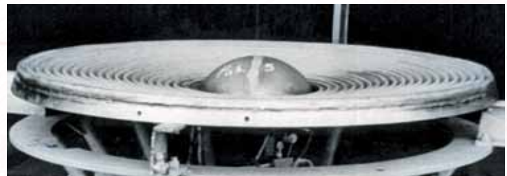
Надувной наконечник головной части до (внизу) и после (вверху) надува
