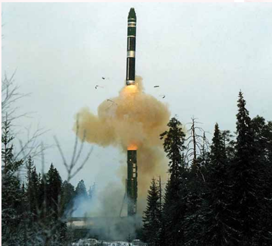
Минометный старт ракеты РТ-23 из пускового модуля БЖРК
