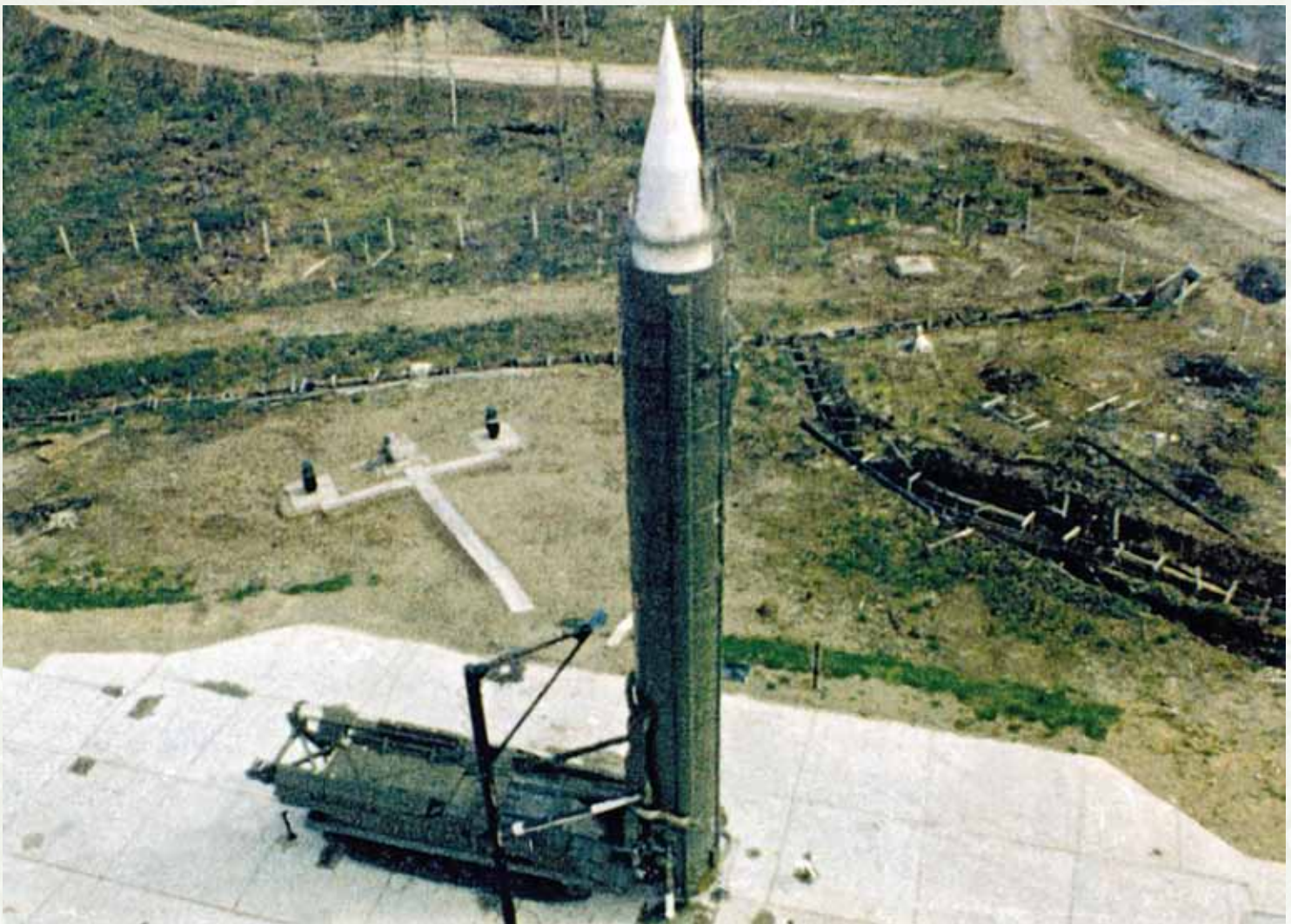
В октябре 1967 года на полигоне Плесецк начались летные испытания первой в мире межконтинентальной ракеты 8К99 в составе подвижного грунтового ракетного комплекса РТ-20П
