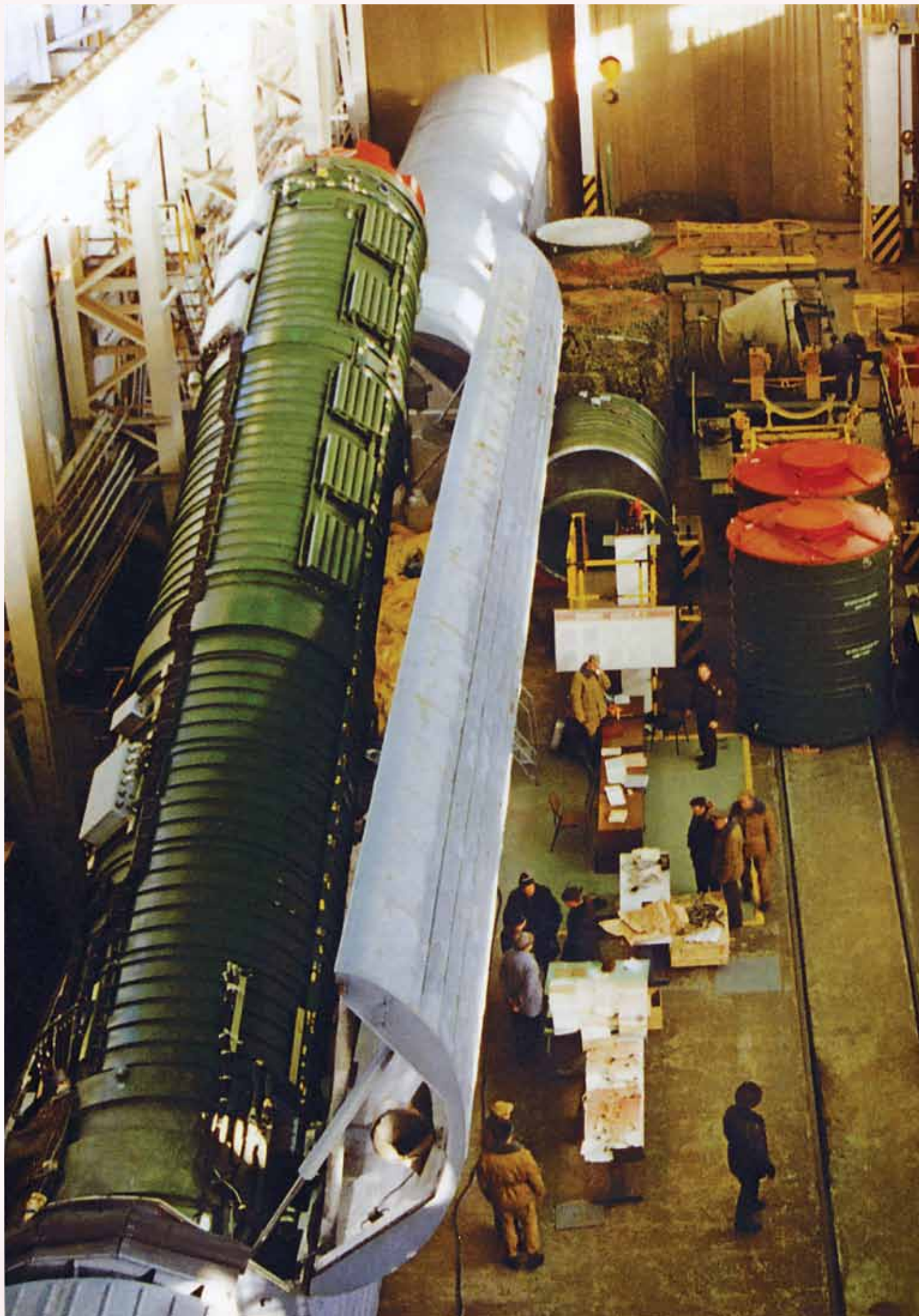
Загрузка контейнера с ракетой РТ-23 в вагон-пусковую установку БЖРК на Павлоградском механическом заводе
