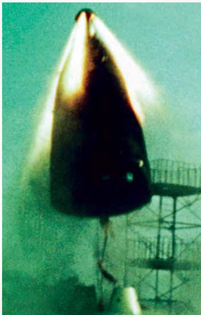
Отработка узла увода головного обтекателя ракеты Р-36М2 (15А18М)
