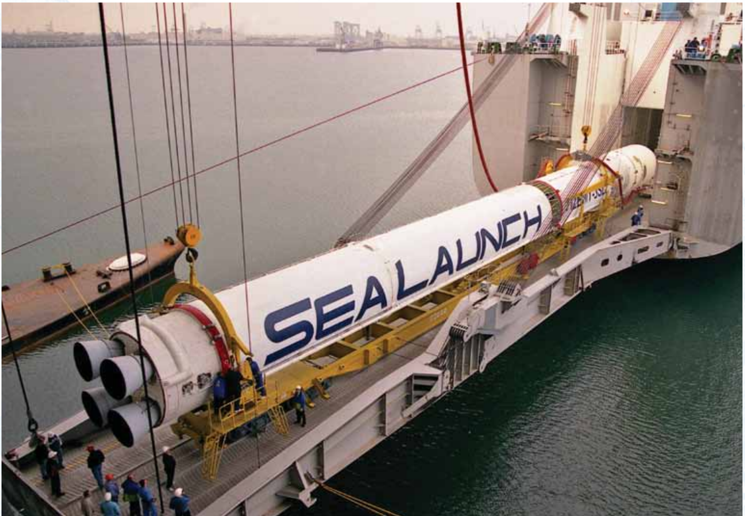
Перегрузка РН «Зенит-3SL» со сборочно-командного судна на стартовую платформу
