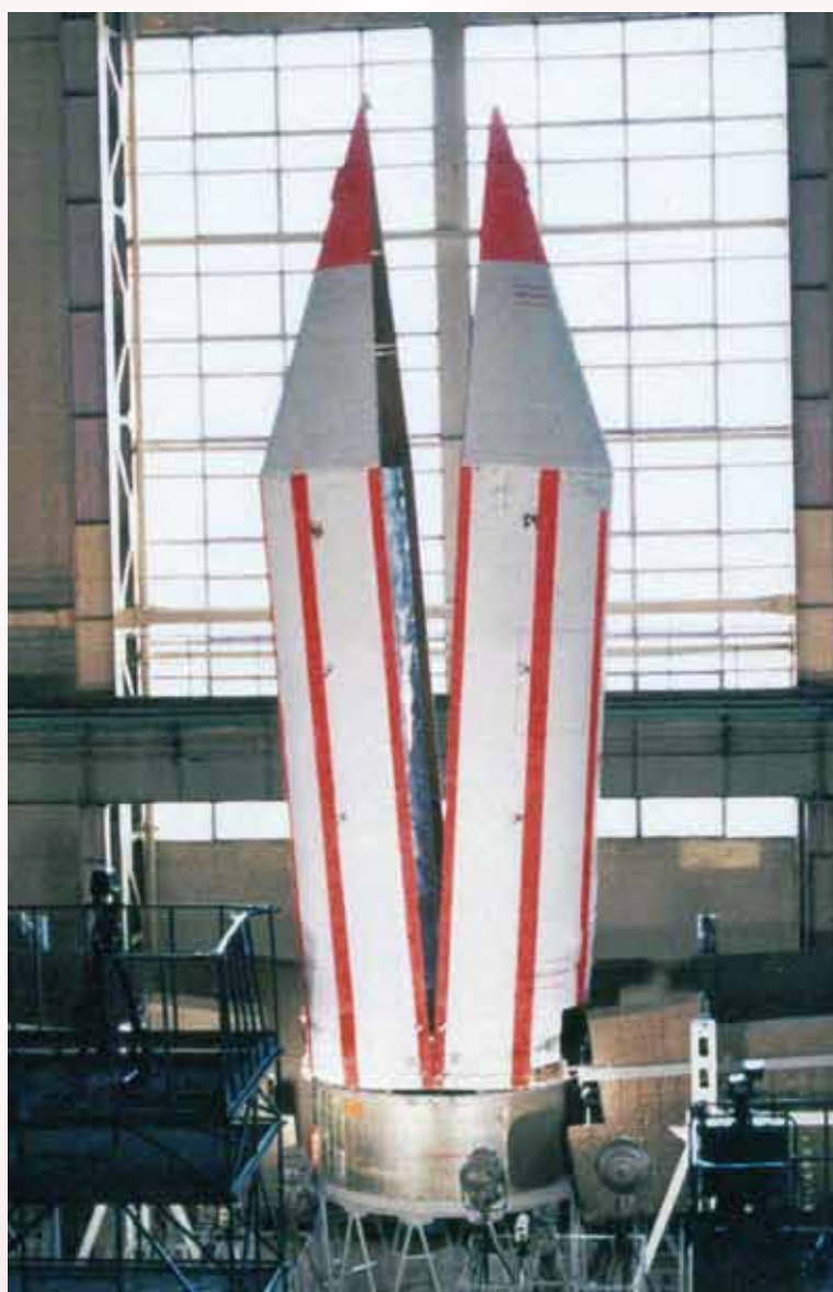
Отработка раскрытия головного обтекателя ракеты-носителя «Зенит»
