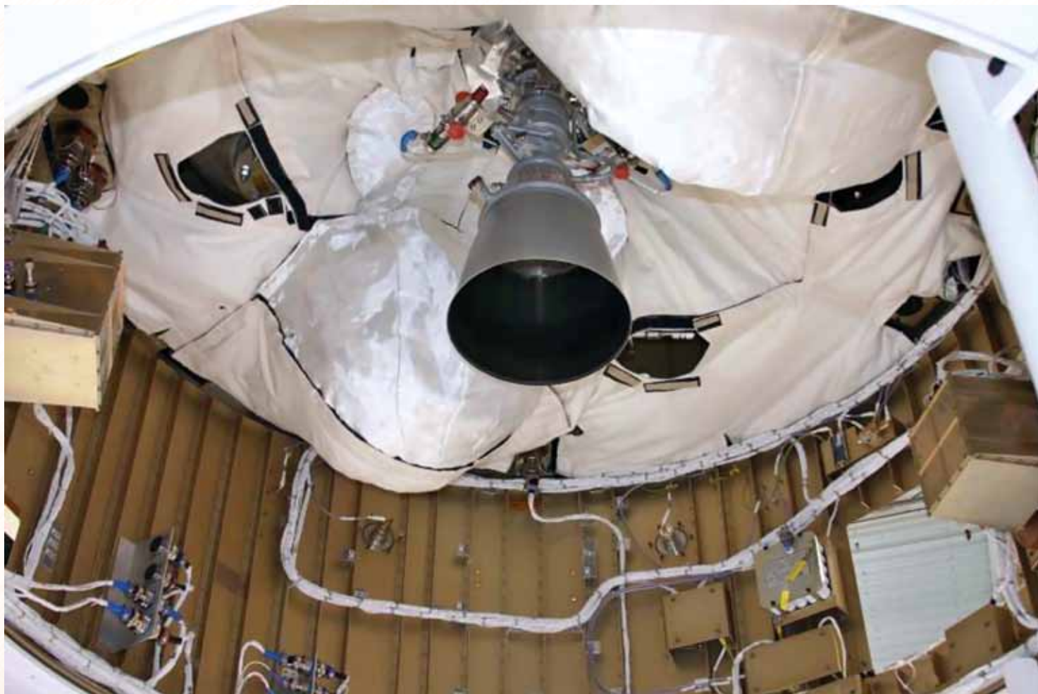
Маршевый двигатель, разработанный КБ «Южное» и изготовленный на Южмаше, установлен на верхнюю ступень европейской РН «Вега», январь 2012 года
