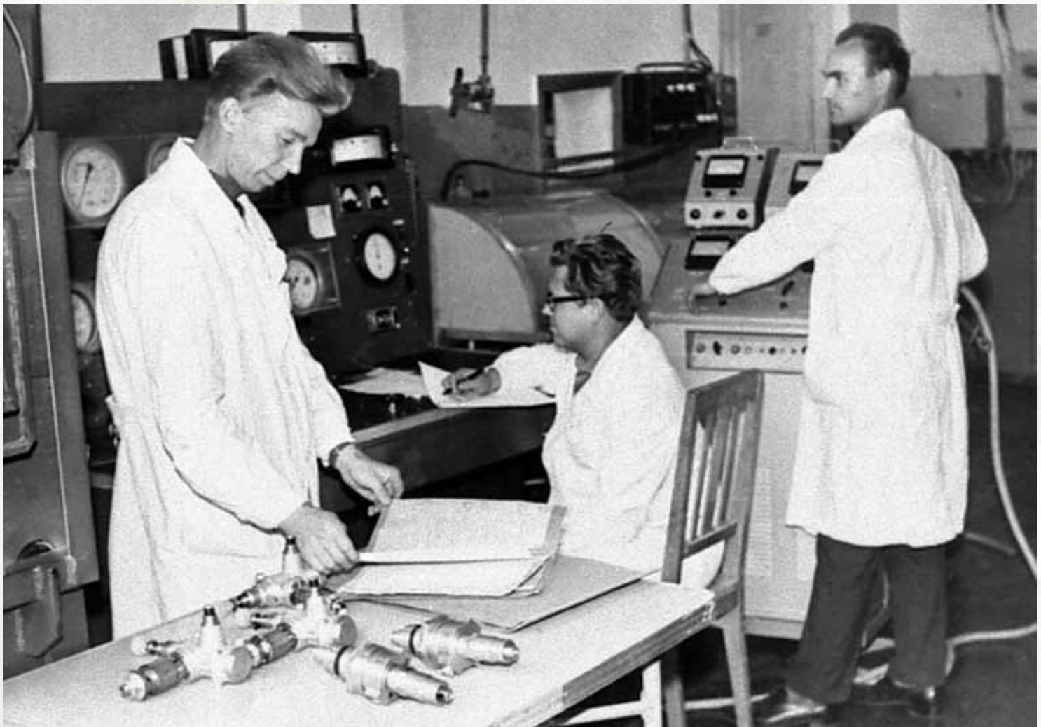
Подготовка к испытанию узлов автоматики ракеты
