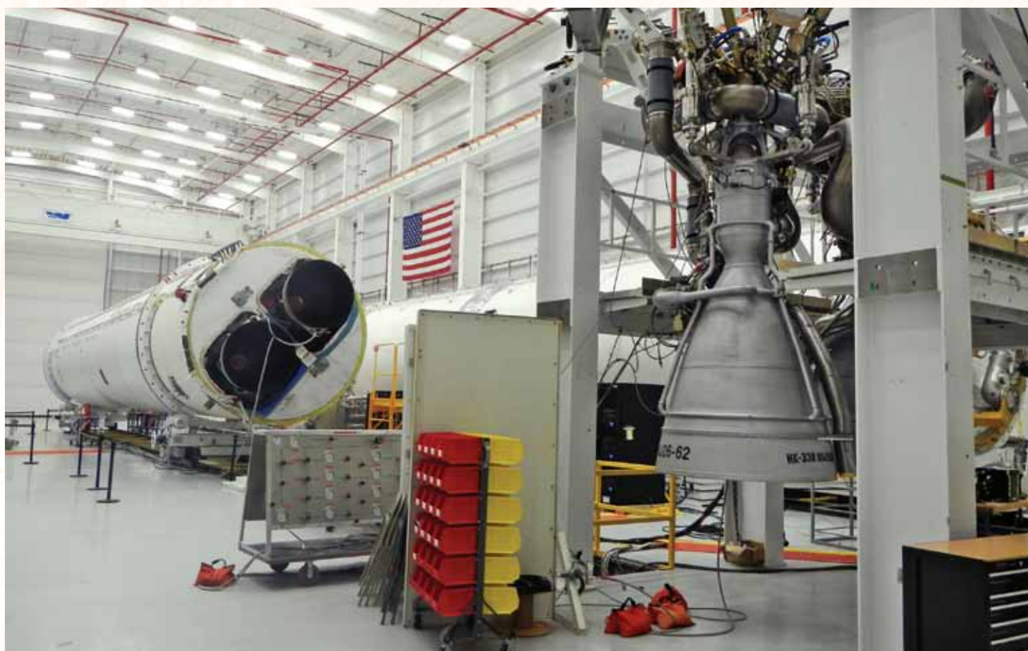
Жидкостный двигатель первой ступени РН «Антарес» разработан и изготовлен в России
