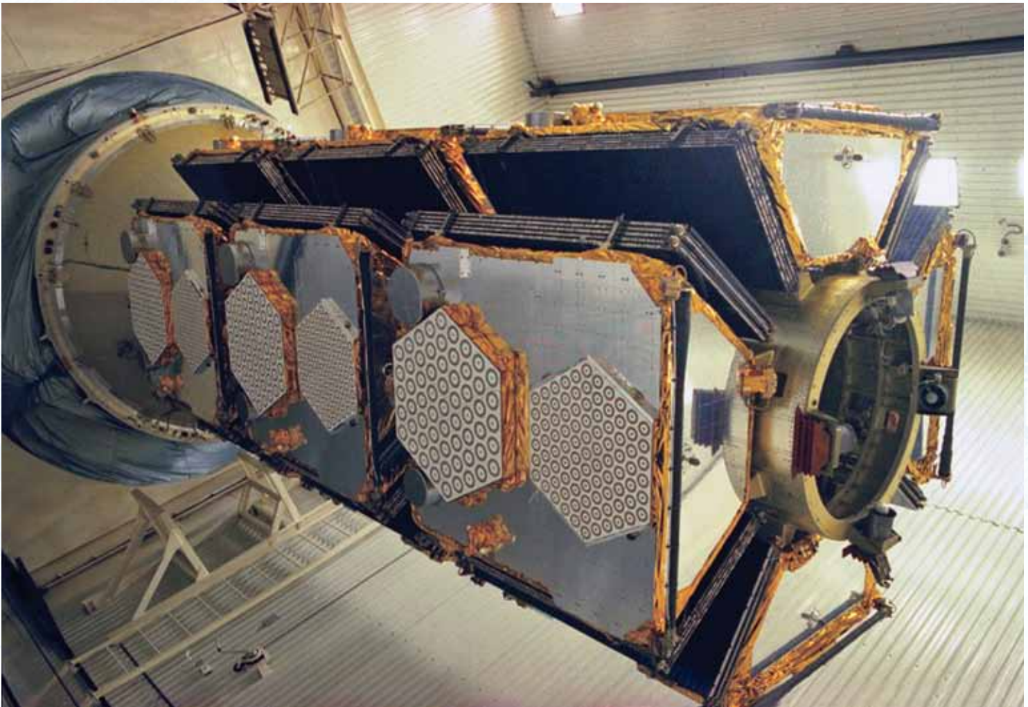
12 космических аппаратов системы Globalstar, установленные на специальном устройстве – диспенсере
