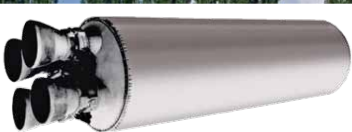
Твердотопливный маршевый двигатель первой ступени ракеты 8К99
