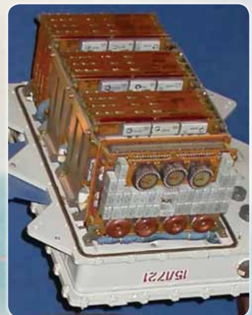
Типовая конструкция бортовых приборов системы управления ракеты Р-36М
