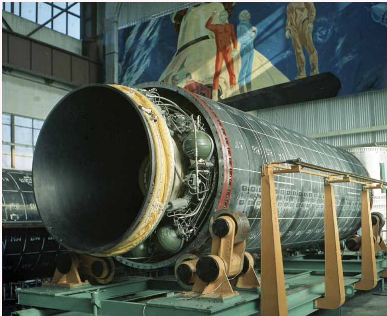
Маршевый твердотопливный двигатель 15Д305 первой ступени ракеты РТ-23
