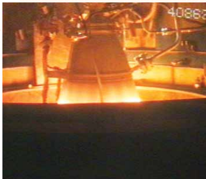
Огневым испытаниям двигателя верхней ступени РН «Вега»
