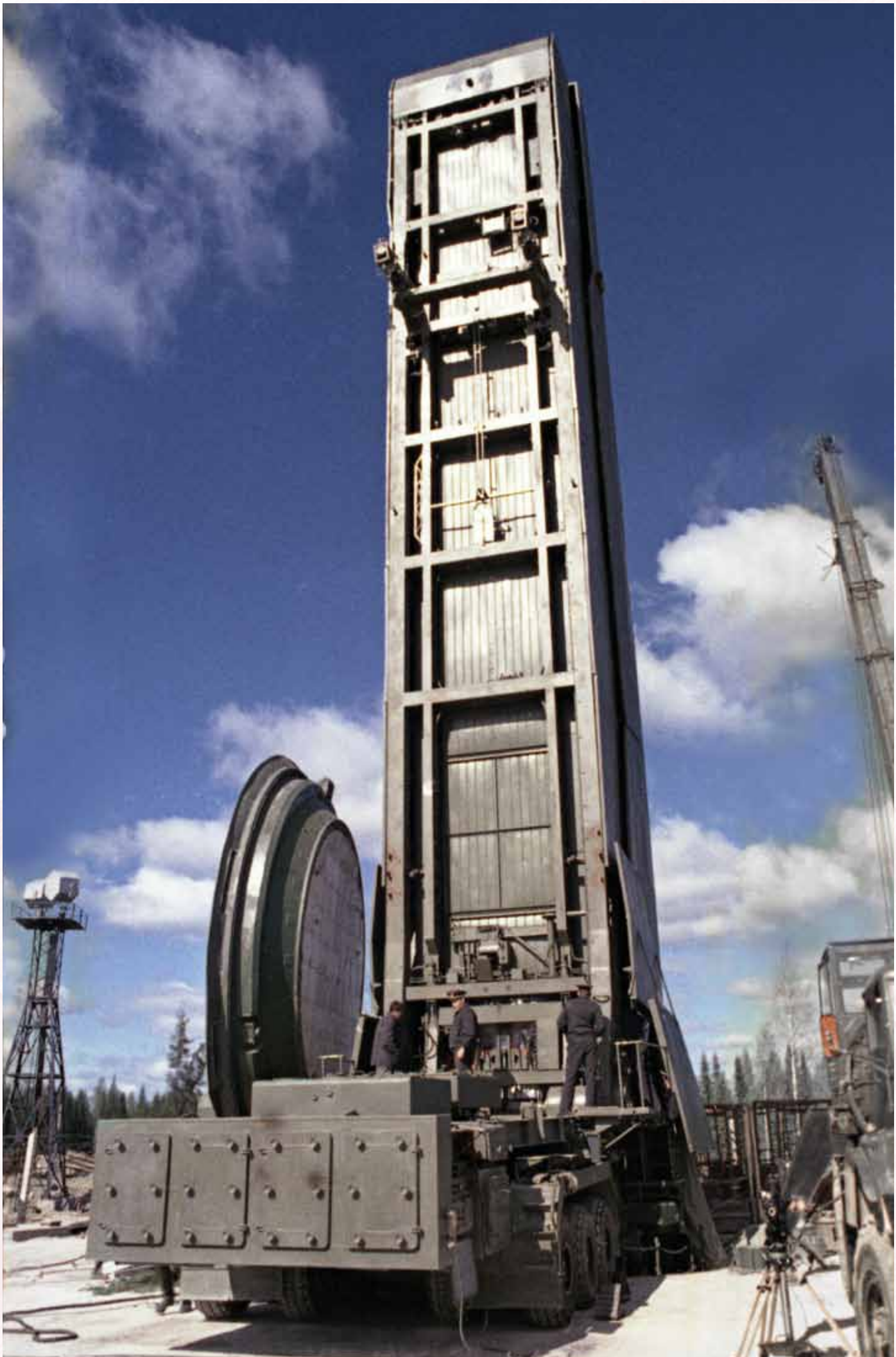
Загрузка ТРК с ракетой в ШПУ
