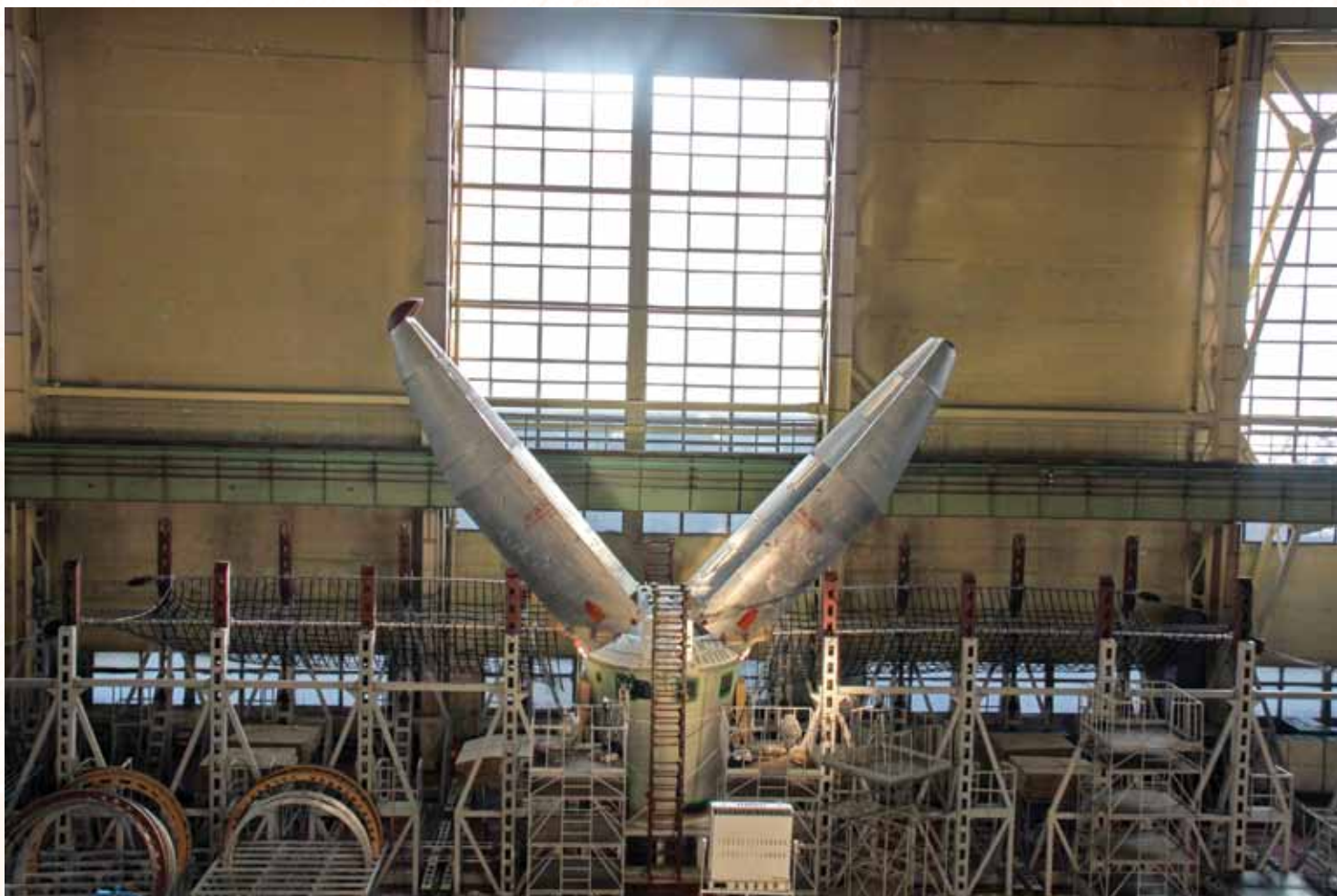
Проверка раскрытия створок головного обтекателя РН «Циклон-4»
