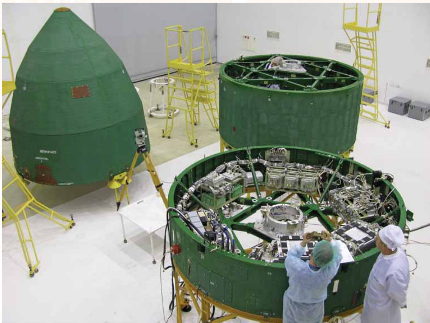
Установка блоков БИНС в космическую головную часть РН «Днепр» для проведения летных испытаний
