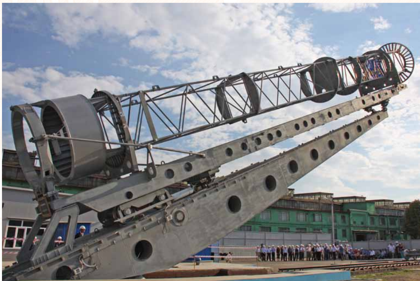
Демонстрация работы подъемно-установочного агрегата РН «Циклон-4» на заводском испытательном комплексе на территории ПАО «Днепрогетмаш» в Днепропетровске
