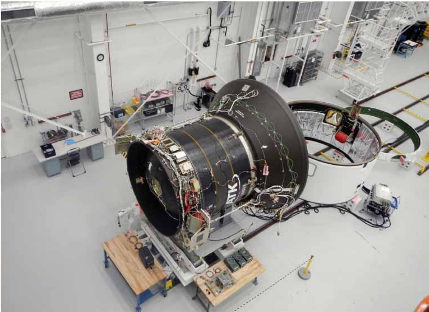
Твердотопливный двигатель второй ступени РН «Антарес» разработан и изготовлен в США
