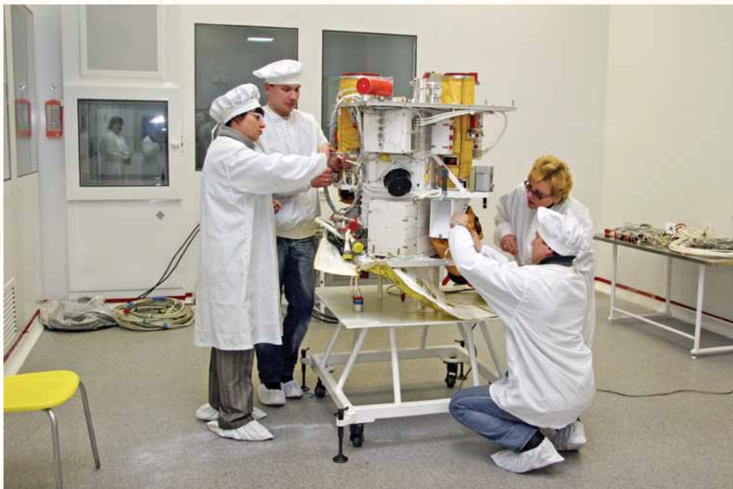
Сборка КА «Сич-2» в чистой комнате в цехе Южмаша
