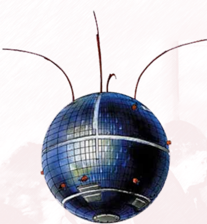
Калибровочный КА «Тайфун-1», предназначенный для отработки специальных наземных средств Министерства обороны СССР. Принят на вооружение в 1978 году
