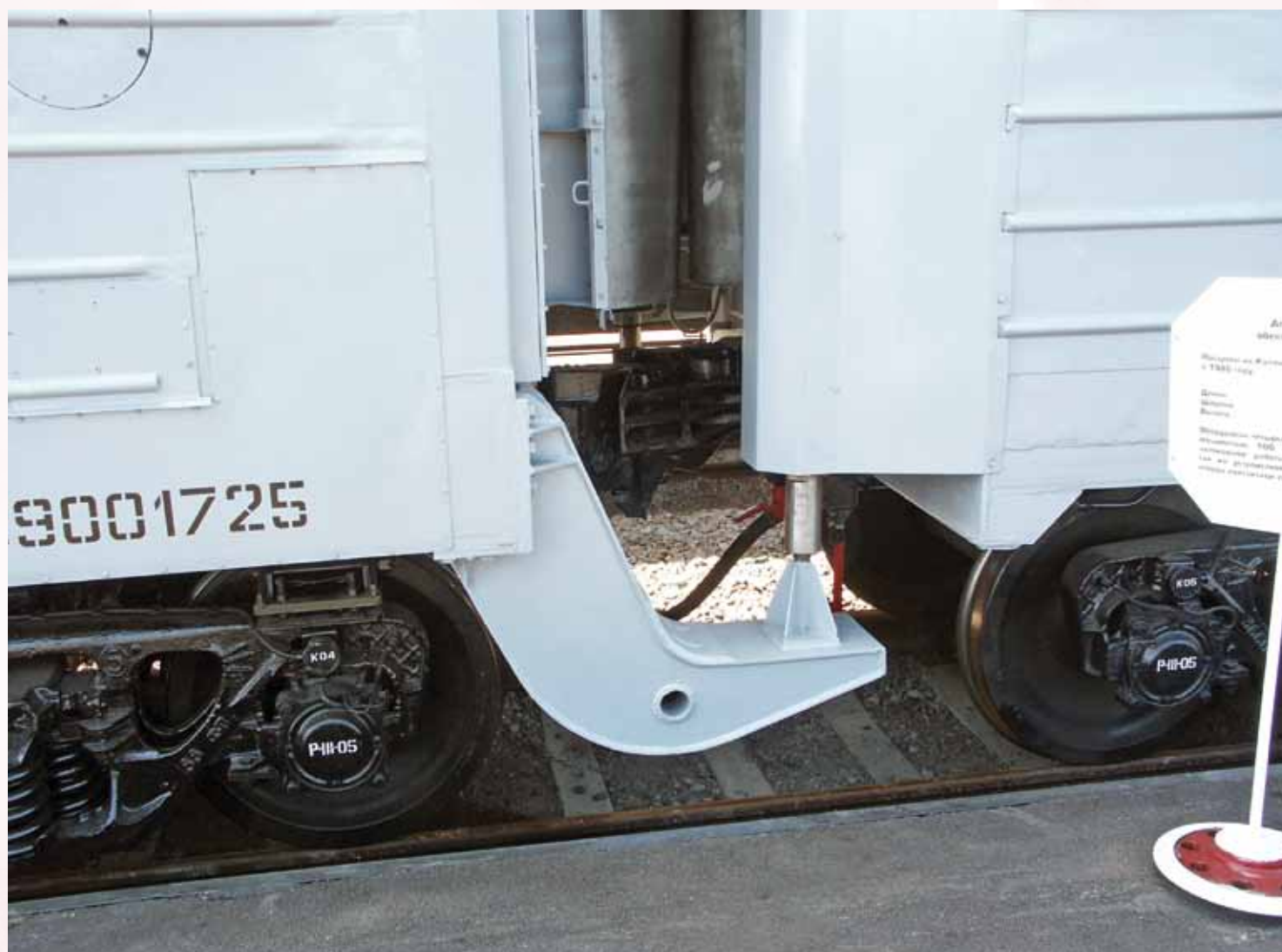
Специальное разгружающее устройство, передающее весовую нагрузку с одного вагона-пусковой установки на соседний вагон
