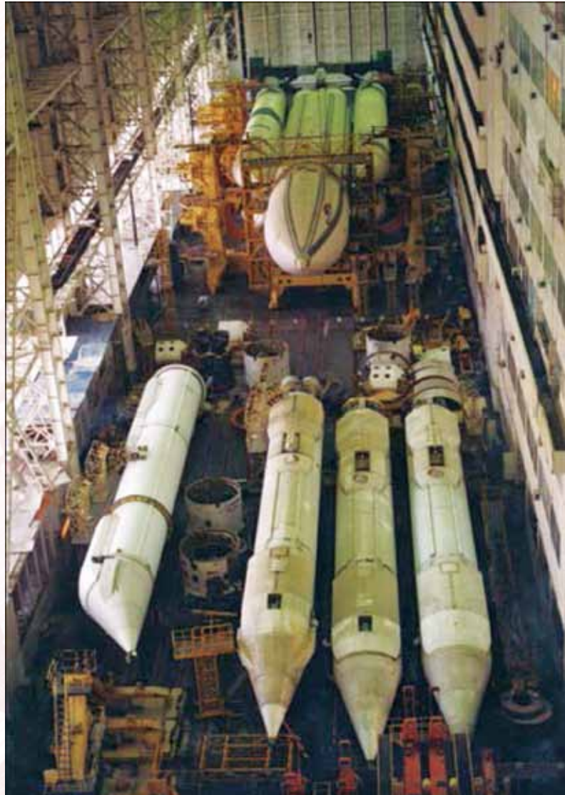
Сборка ракеты-носителя «Энергия» в МИКе космодрома Байконур. На переднем плане – четыре боковых блока первой ступени разработки КБ «Южное» и изготовления ЮМЗ
