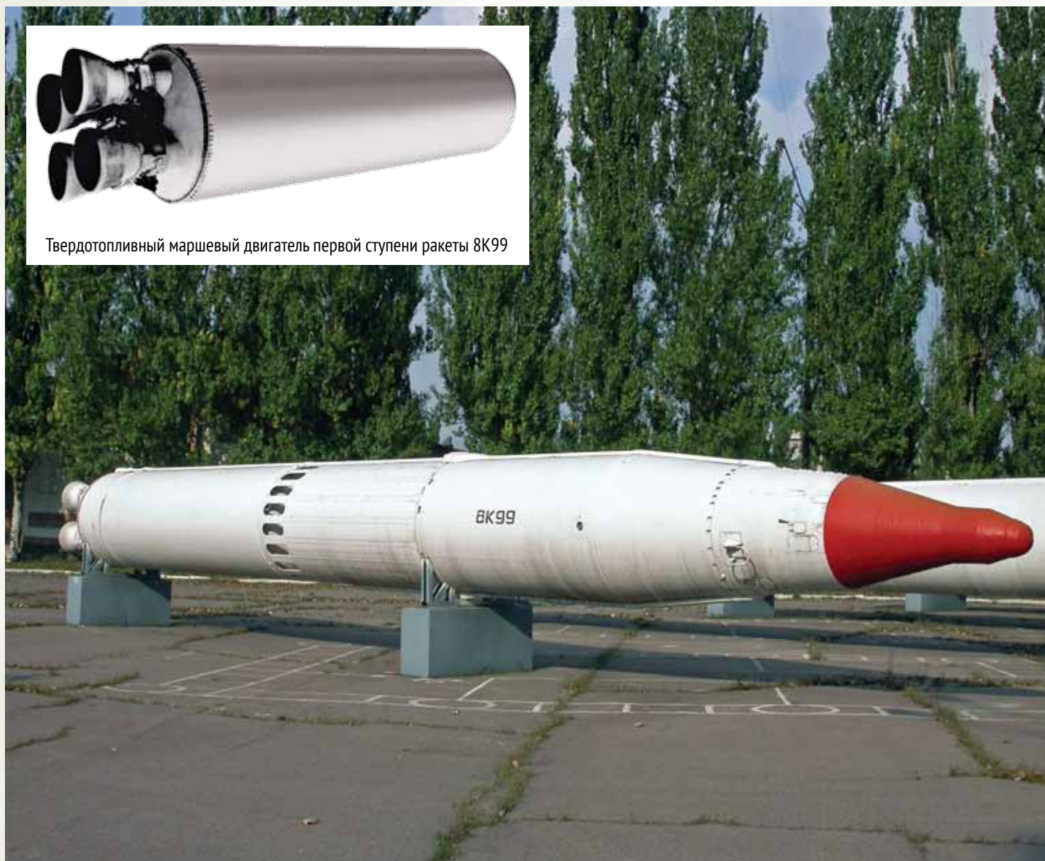
Экспериментальная ракета 8К99 с твердотопливной первой и жидкостной второй ступенями
