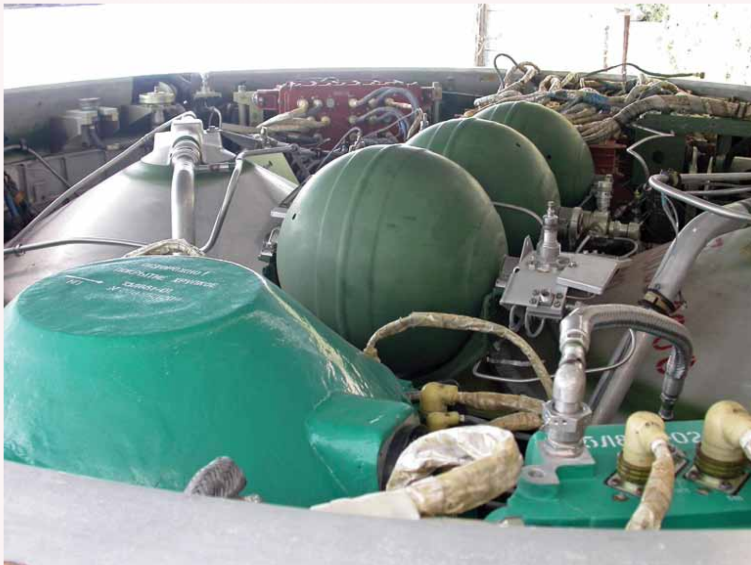
Шаробаллоны высокого давления на ракете Р-36М2
