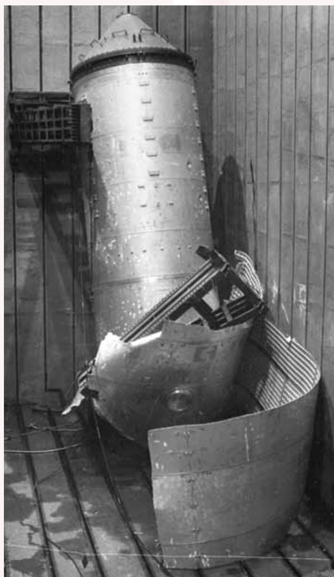
Разрушенный топливный бак РН «Зенит» после испытания внутренним давлением
