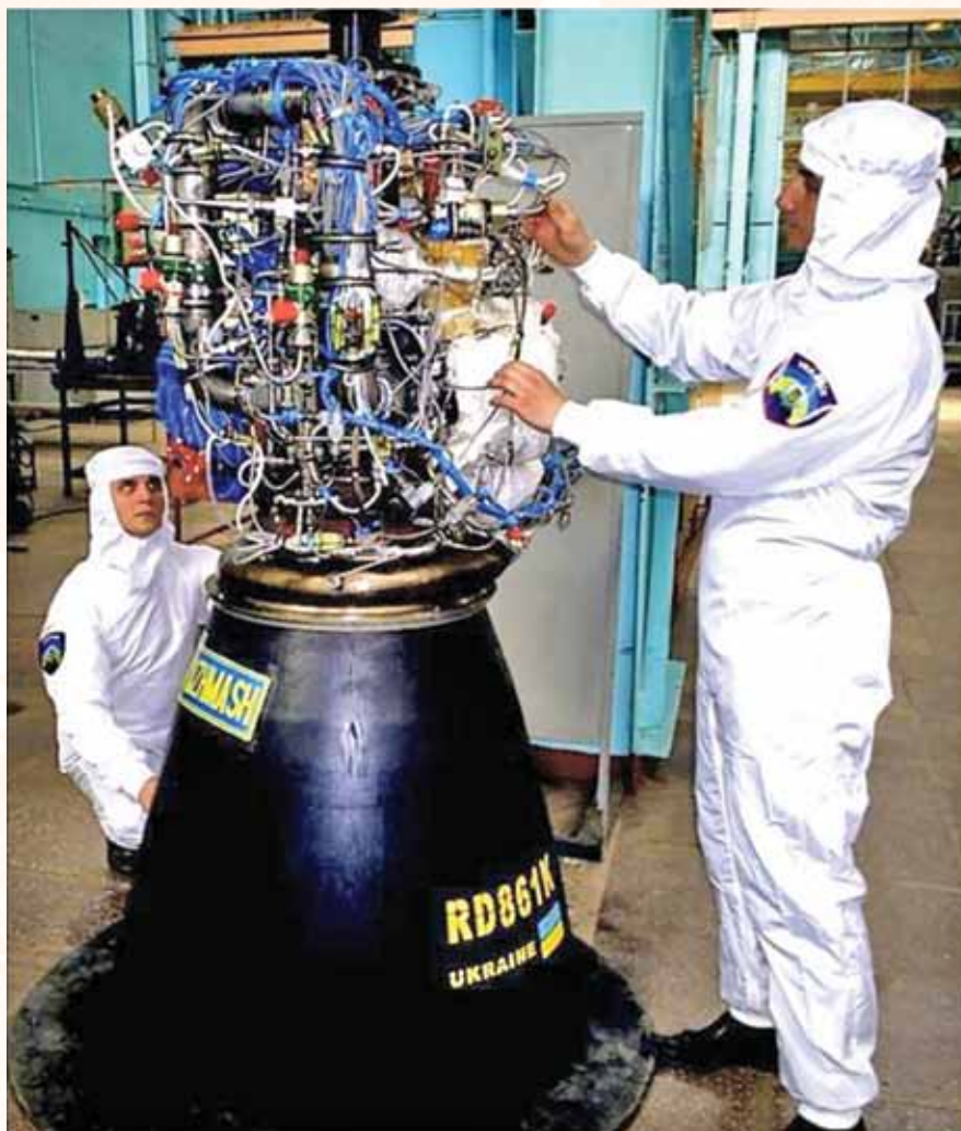
Подготовка к огневым испытаниям маршевого двигателя РД861К третьей ступени РН «Циклон-4»
