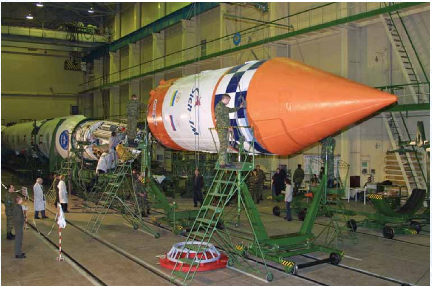
Накатка обтекателя на головную часть РН «Циклон-3» с КА «Сич-1М» и «Микрон»
