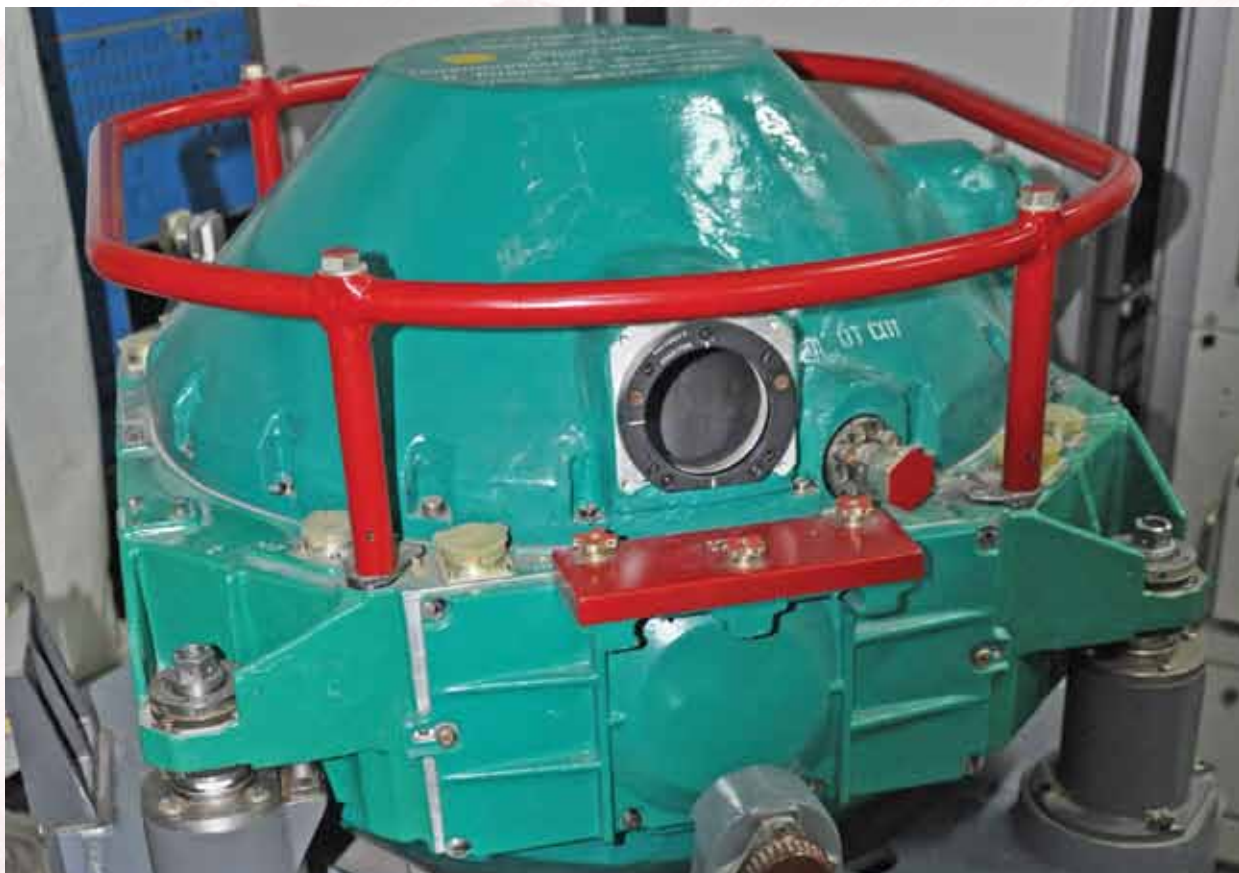
Гиростабилизированная платформа системы управления ракеты Р-36М2
