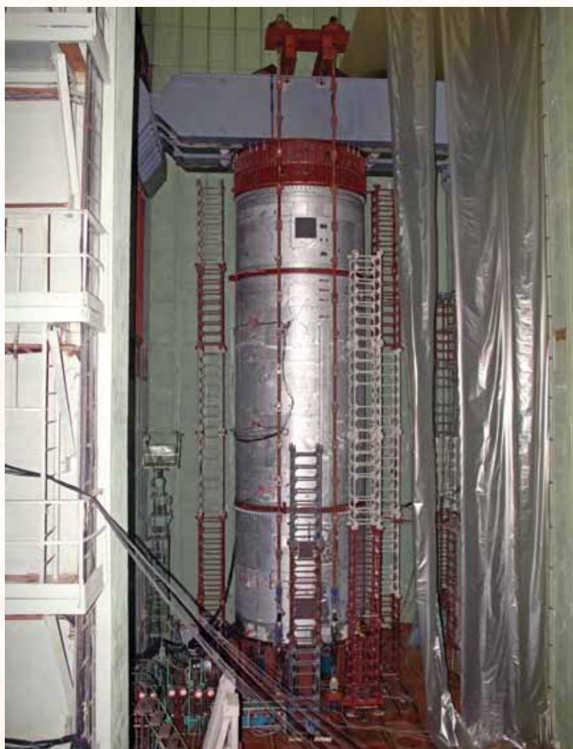
Испытание основной конструкции 1-й ступени РН «Антарес» нагрузками от двигателя
