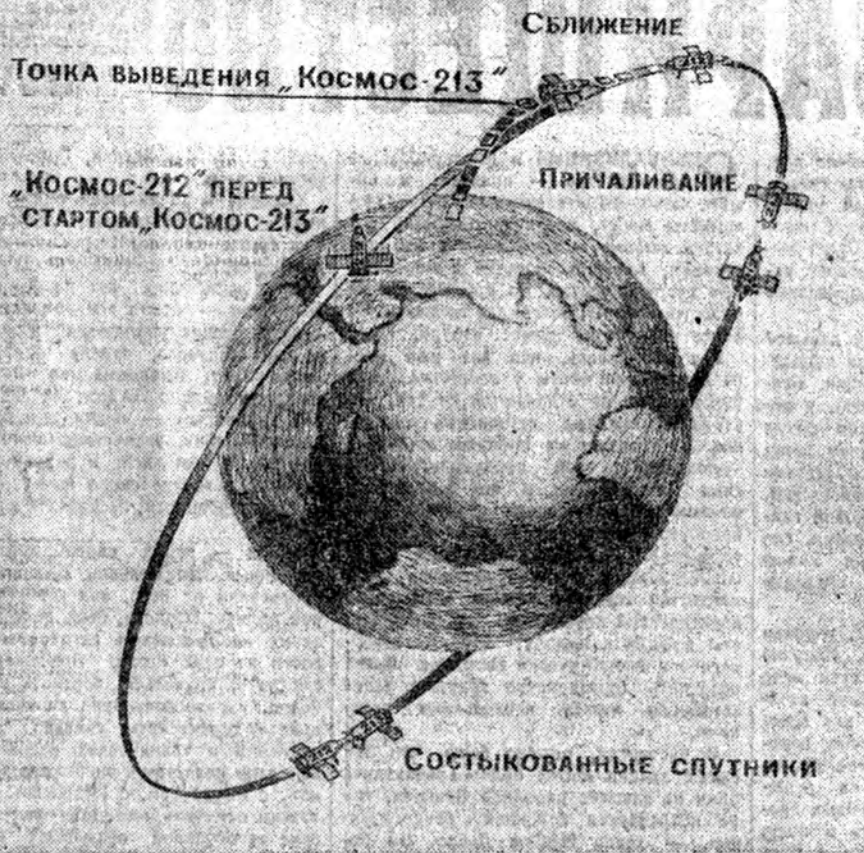
Схема автоматического сближения и стыковки спутников «Космос-212» и «Космос-213».
