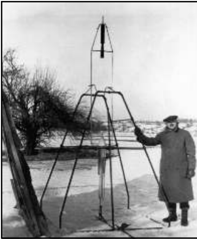
Robert H. Goddard mit der ersten Flüssigkeitsrakete der Welt, am 16. März 1926 gelang damit ein Flug von nicht ganz 3 Sekunden Dauer.
