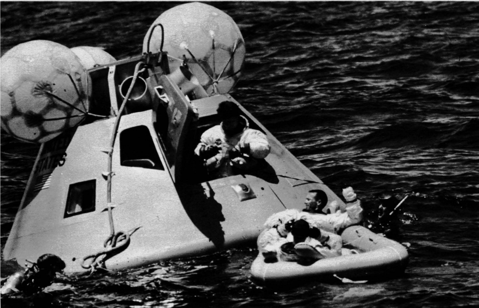
Exercice d'amerrissage : la capsule est dotée d'un émetteur de secours à très haute fréquence et de trois ballons de stabilisation. L'intérieur d'Apollo VII (7 350 ki
