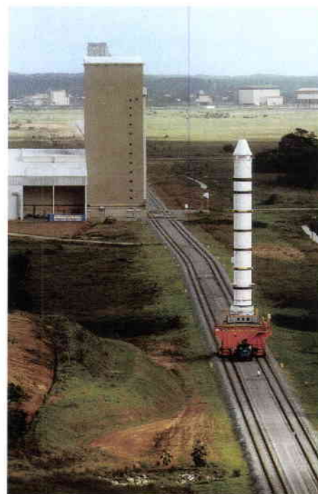
Propulseur à poudre P230 d'Ariane-5 pendant son transport vers le banc d'essai à Kourou
