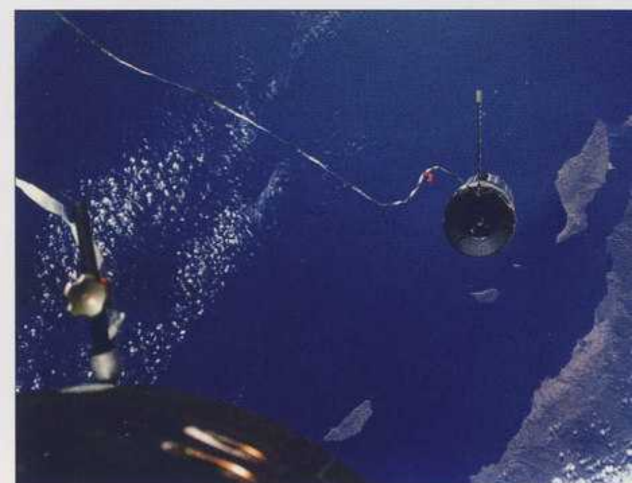
Mise Gemini 11 se zapsala do historie mimo jiné spojením s cílovým tělesem Agena pomocí třicetimetrového lana
