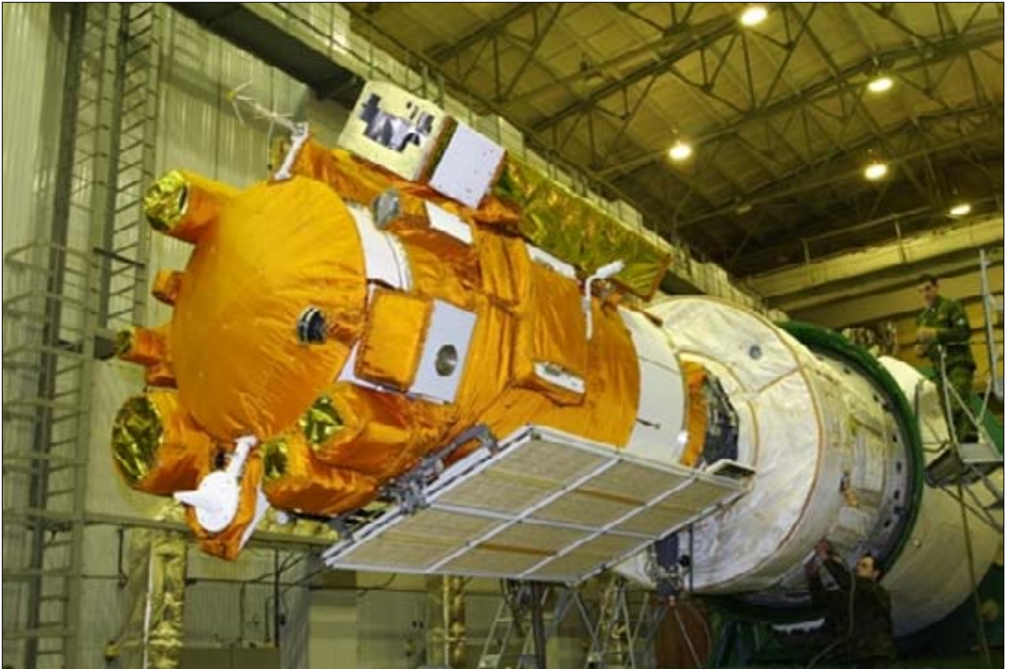
Космический аппарат «КОРОНАС–Фотон», установленный на ракете-носителе перед накаткой обтекателя. На переднем плане, выше солнечных батарей – блок СТЭП–ФД. На белом фоне корпуса блока хорошо виден, темный конический «тубус» детекторной головки блока (защитная крышка уже снята)
