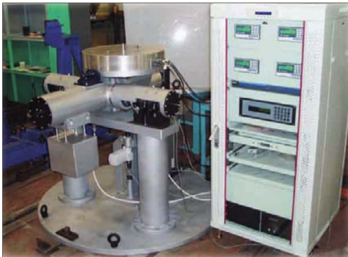
Стенд для контроля массы и координат центра масс АСКМ
