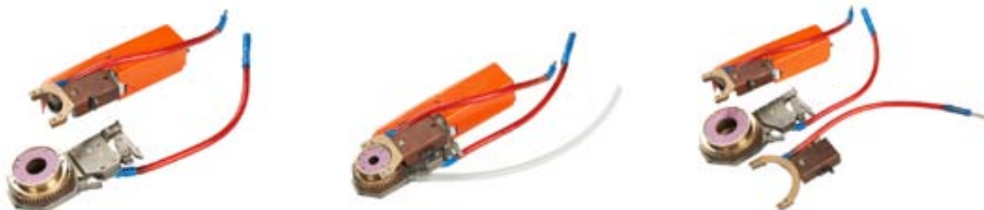
Комплект малогабаритных головок для орбитальной сварки трубопроводов ГСК-1
