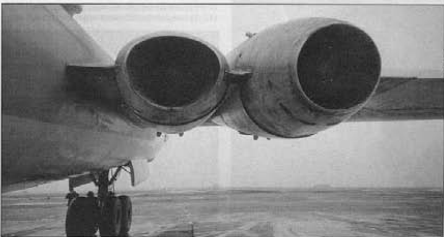
Сопловая часть мотогондол Nozzle part of the nacelles
